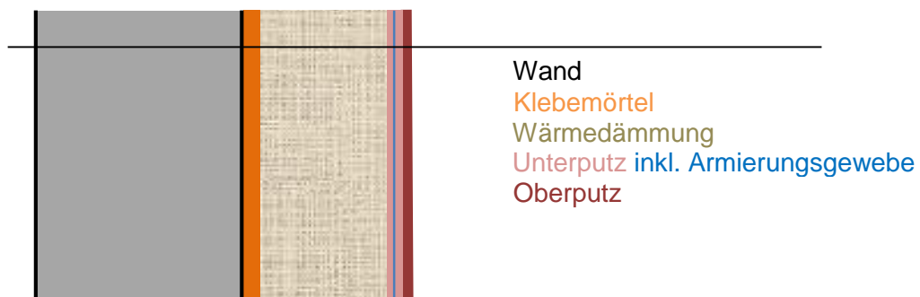
Abb. 44: Systemaufbau WDVS gemäß [61]: Abb. 130.3-01
