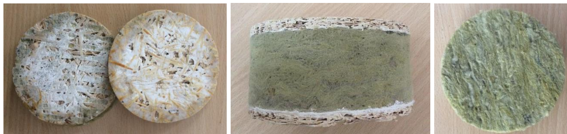
Abb. 30: Schichtaufbau der Holzwolle-Dreischicht-Platte
