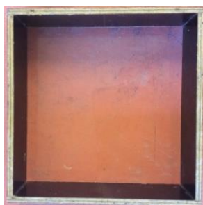
Abb. 55: Verwendeter Holzrahmen zum Einbau der Folie ohne Steinwolle
