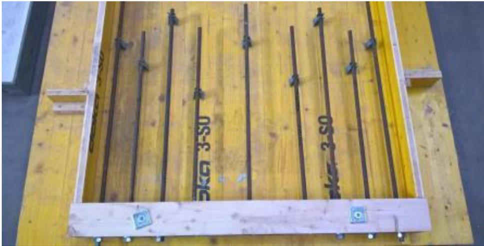
Abb. 4.11.: Einleitungsbewehrung zur Lastübertragung vom Zwangrahmen in den Versuchskörper
