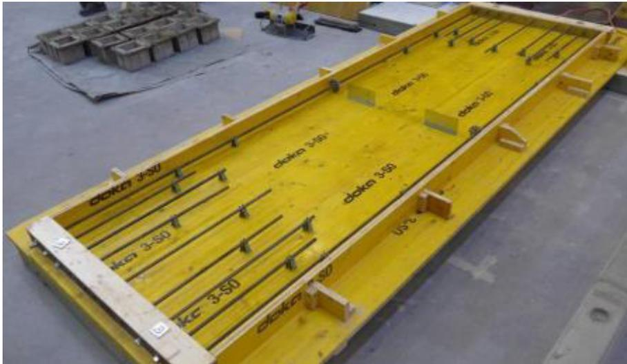
Abb. 4.13.: Schalungsaufbau Versuchskörper II
