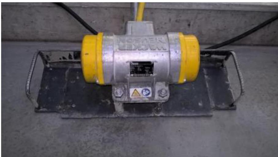
Abb. 4.17.: Rüttelplatte zur Verdichtung des Betons im Versuchskörper
