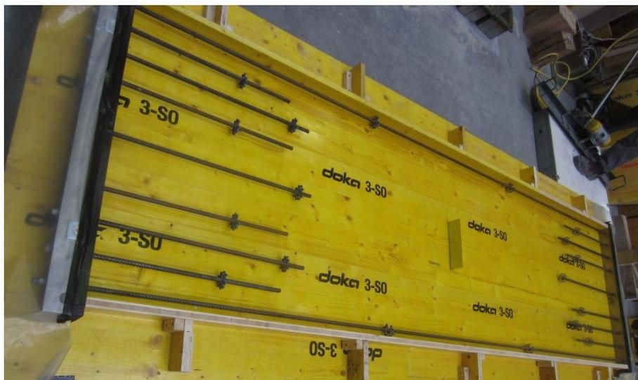
Abb. 4.12.: Schalungsaufbau Versuchskörper I
