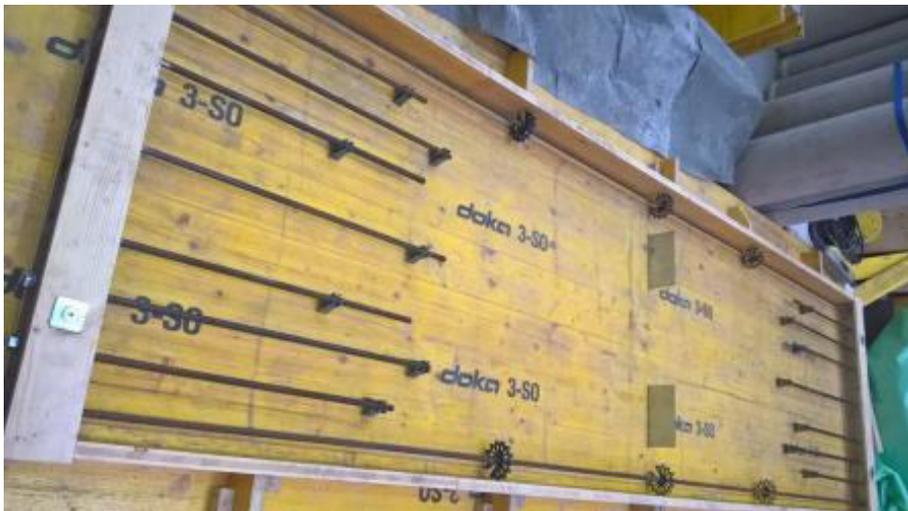
Abb. 4.14.: Schalungsaufbau Versuchskörper III
