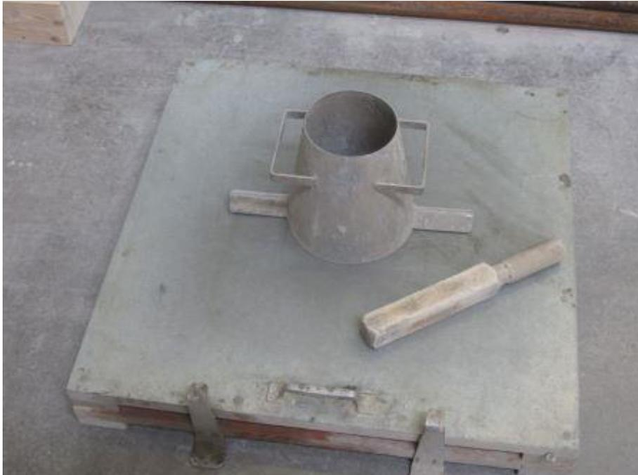
Abb. 4.16.: Zubehör für den Ausbreitmaßversuch bestehend aus Ausbreittisch und kegelstumpfförmigem Behälter
