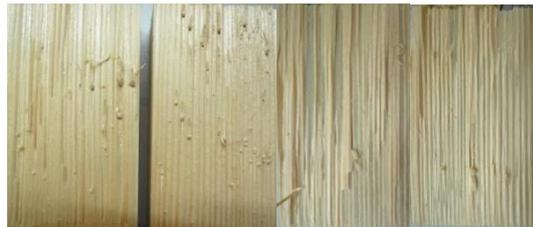
S-PU-SA09  $F_{\max} = 50,63 \text{ kN}$
