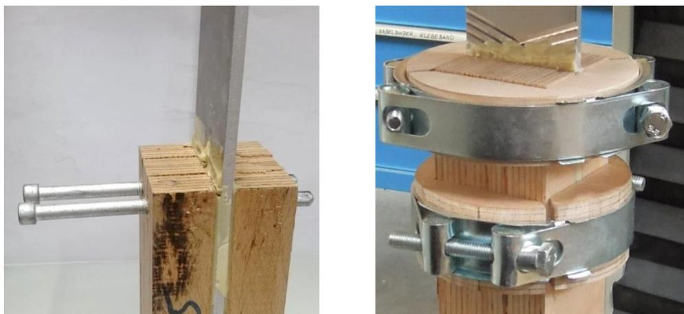
Abbildung 6.14: Bohrstabdübel (links), Schellen (rechts)
