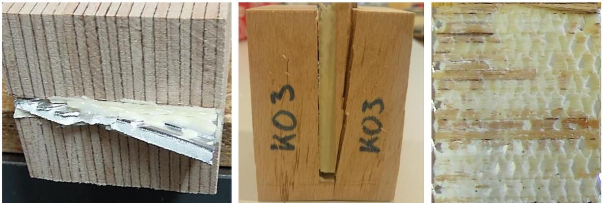
*Abbildung 4.5: Versagensbilder von Verbindungen mit in Holz eingeklebten Blechen: Aluminiumbruch (links), Holzbruch (Mitte), Kohäsionsversagen im Klebstoff (rechts)*
