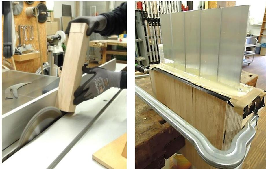
Abbildung 6.15: Herstellen der Prüfkörper
