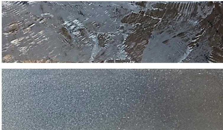
*Abbildung 6.36: Oberflächenprofilierung (geschliffen oben, sandgestrahlt unten)*
