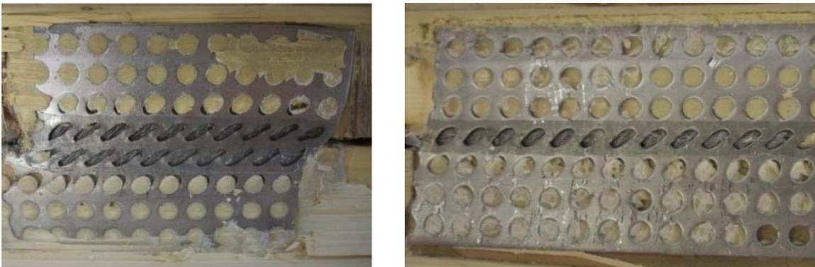
**Abbildung 3.31: Versagensmechanismen unter einfacher Scherbelastung: kurzes Blech mit zwei abgeklebten Reihen (links); langes Blech mit einer abgeklebten Reihe (rechts), [59]**
