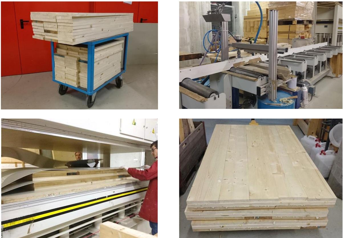
*Abbildung 6.37: Herstellungsschritte der BSP-Platten*
