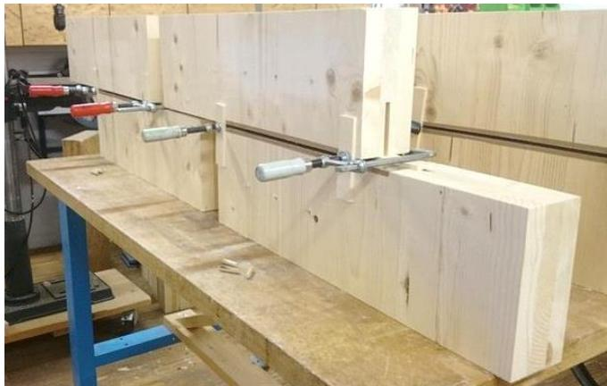
*Abbildung 6.38: Herstellungsschritte der BSP-Prüfkörper*
