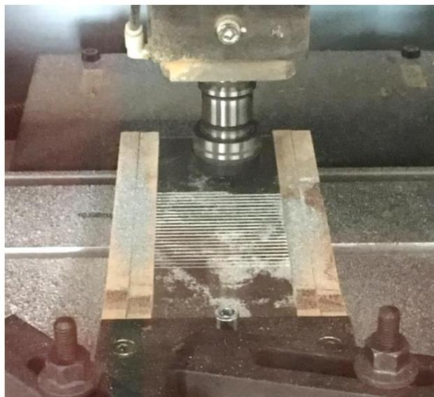
*Abbildung 6.6: Herstellen der Oberflächenprofilierung*
