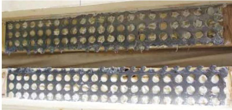
*Abbildung 3.32: Versagensmechanismus unter zyklischer Scherbelastung, [59]*
