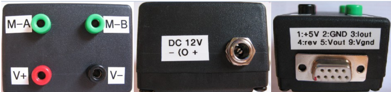
Abbildung 81: Gehäuse für die Messschaltung; Ansicht: von oben, von links, von rechts
