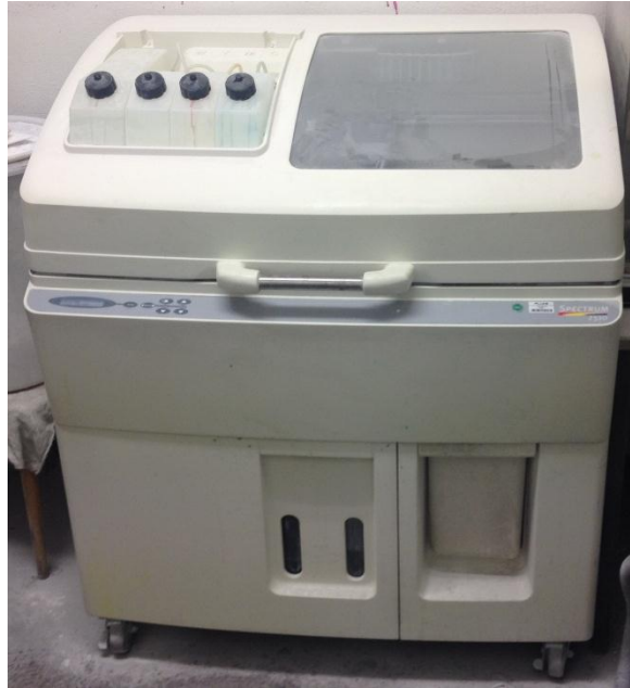
Abbildung 6-8: 3d Drucker der Firma Z-Corp
