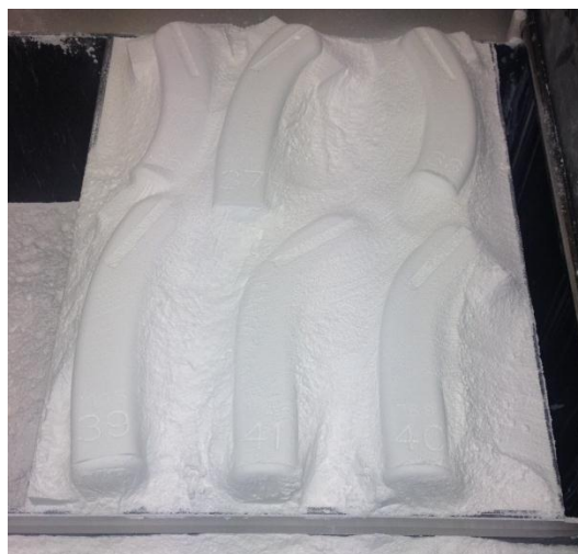
Abbildung 6-9: Flowbox-Teilstücke im Bauraum des 3d-Druckers
