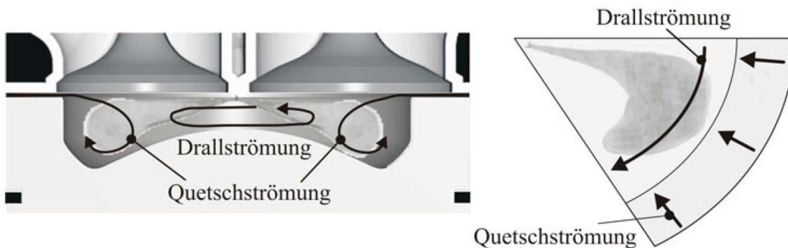
Abbildung 2-2: Quetsch- und Drallströmung [2]
