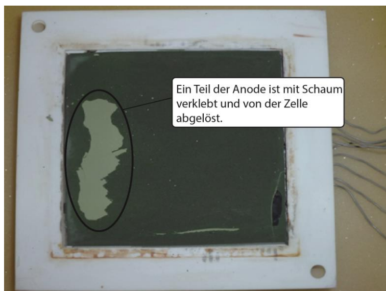
Abbildung 5.5 Oxidierter Nickelschaum - Anodenkontaktierung
