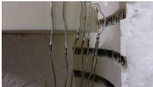
Abbildung 4.12 Zusammengeschweißte Platindrähte der Stromabnahme
