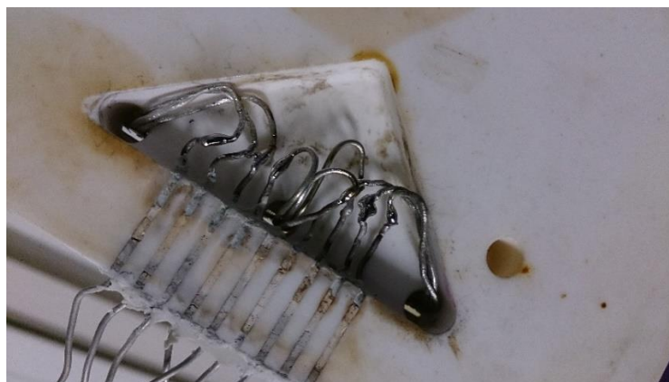
Abbildung 4.5 Unterseite der Anodenplatte mit den verschweißten Platindrähten
