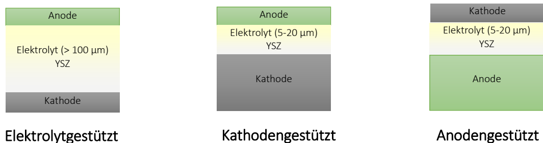
Abbildung 2.7 Strukturaufbau planarer SOFCs
