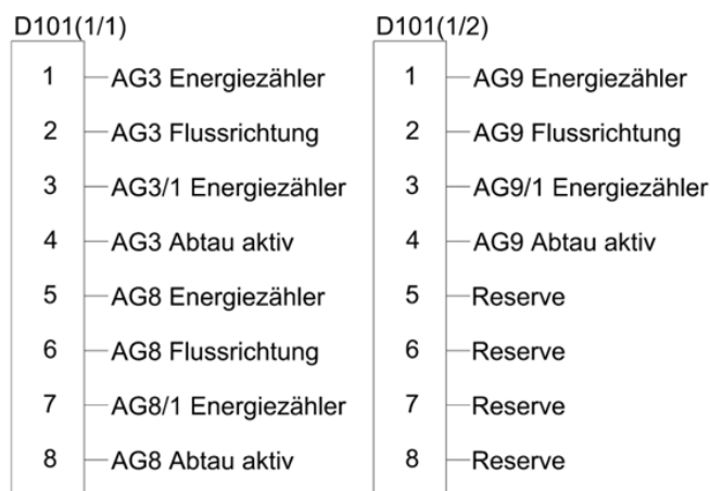
Abbildung 15: Belegung der digitalen Module D101 (softwareinterne Bezeichnung D101(1/1) bzw. D101(1/2) mit den Messpunkten (Energiezähler, Flussrichtung, Abtau)
