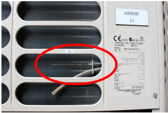
Messstelle: t_{\text{outdoor,in}} (Thermoelement Typ K)
