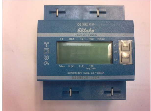
Abbildung 19: Pt100-Temperaturfühler (links) und elektronischer Drehstromzähler Eltako DSZ 12D-3x65 A (rechts)
