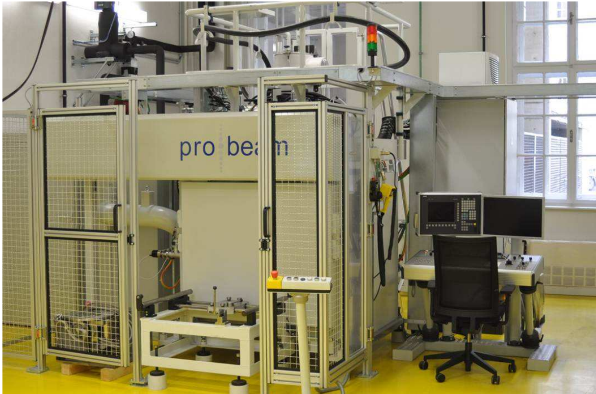
Abbildung 27: Elektronenstrahlschweißanlage des Instituts für Werkstoffkunde und Schweißtechnik der TU-Graz
