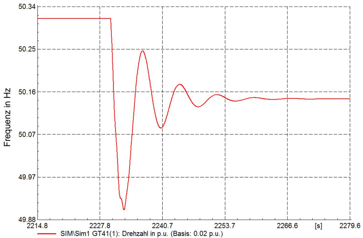
Abbildung 4.11: S1B - Zuschaltung Borealis 66 MW
