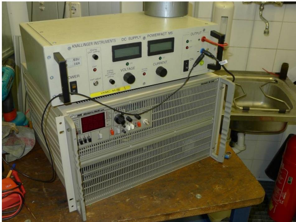
Abbildung 39: Oben Netzgerät zur Versorgung beim Starten, unten "DC-Load"
