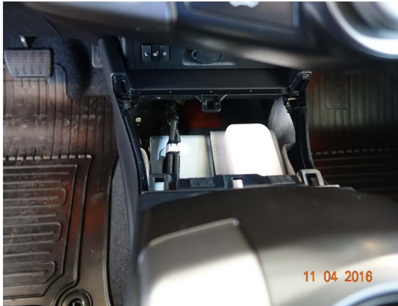
Abbildung 3-12: Batterieunterbringung im Toyota Prius+
