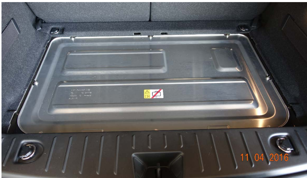
Abbildung 3-21: Serviceklappe des Elektromotors im Laderaum
