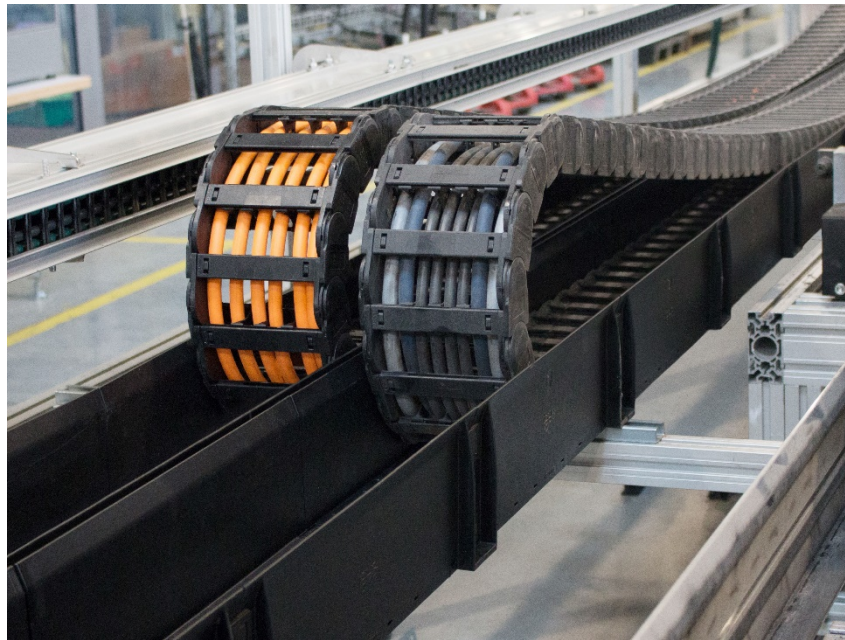
Abbildung 3-6: Beispiel eines Kabelschlepps [45]
