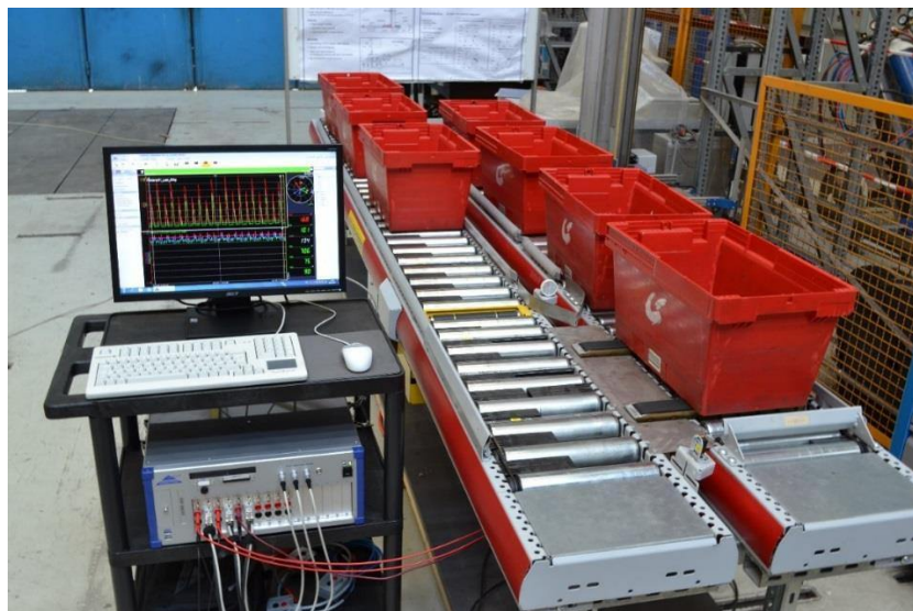
Abbildung 5-1: Rollenförderer mit Zentralbandantrieb inkl. Messsystem
