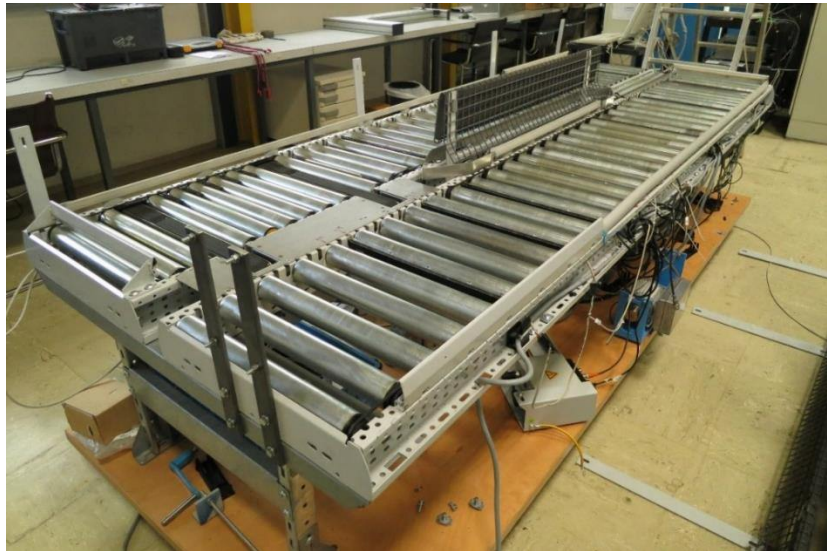
Abbildung 5-3: Rollenförderer mit Motorrollenantrieb
