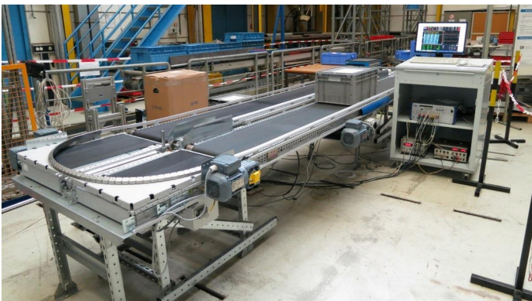
Abbildung 5-5: Bandfördererprüfstand mit Messsystem
