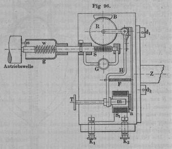
drehungszahl von Motor und Stromerzeuger zu messen. Rechnet man die Umlaufszahlen auf gleiche Polzahl um, so stellt die Differenz beider die Schlüpfumdrehungszahl dar.
