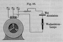
Kohlenstifte gleichmäßig erhitzt, während bei Betrieb mit intermittierendem Strome einer Richtung ungleichmäßige Erhitzung eintritt, welche durch Anordnung der +-Kohle — d. i. der oberen mit der Aluminium-ektrode verbundenen — noch begünstigt wird. Die obere, sowieso heißere Kohle, wird durch die warm aufsteigende Luft nur sehr langsam abgekühlt, wohingegen die untere — durch kalte hinzukommende Luft
