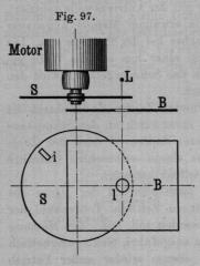
versehen. i passiert für jede Umdrehung das Loch l und das Licht der Lampe leuchtet durch i auf das durchscheinende Papier. Das durchscheinende Papier leuchtet somit bei jeder Umdrehung auf, und zwar so, daß die Zählung auch bei großer Umdrehung noch gut erfolgen kann. Bedeuten b die Lichtblitze in der Zeit t, so ist die Schlüpfung in Prozenten bezogen auf die primäre
