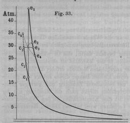
und starke Stöße, bei höheren Kompressionen etwa 9 Atm., zu vermeiden. Durch die Kühlung wird jedoch eine gute Verdampfung beeinträchtigt. Bei großen Maschinentypen ist die Vorzündungsgefahrnoch größer, da der Einfluß der Kühlung nur klein ist und die Gleichmäßigkeit der Mischung komplizierter wird. Dieselmotor sind alle die angeführten Komplikationen vermieden, da-
