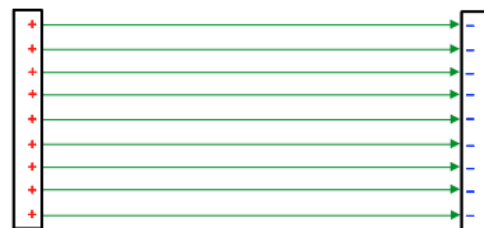
Abb. 18 Äußeres Feld ohne elektrischen Leiter
