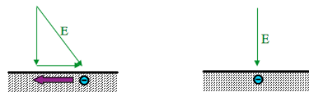
Abb. 21 Einfluss des elektrischen Feldes auf freie Elektronen im Leiter
