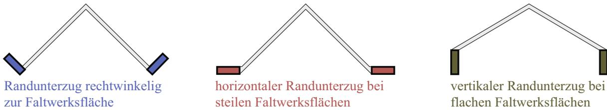
*Abbildung 2.6: Randunterzüge zur Stabilisierung des freien Faltwerksrandes [2]*
