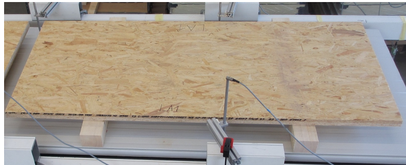
Abb. 5.24: Lastverteiler-Konstruktion beim GSP-Rahmentest
