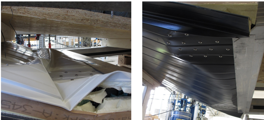
Abb. 5.32: Versagensbild beim Probekörper 4000-13 (Einschubling Typ 4) an der Oberseite (links) und Unterseite (rechts)
