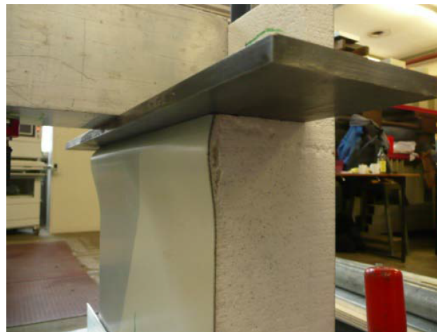
Abb. 6.11: Versagen im Lasteinleitungsbereich durch Knicken des freien Deckblechendes [19]
