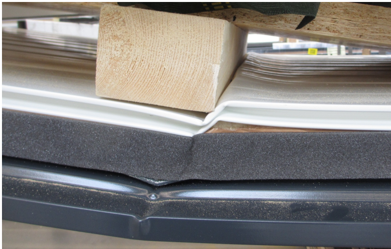
Abb. 2.9: Knitterfalte beim 6-Punkt-Biegeversuch
