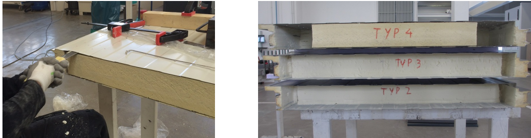
Abb. 5.20: Herstellen der Einschubling-Negativformen im Paneel bei Typ 1 (links) bzw. vollendete Negativformen bei Typ 2-4 (rechts)
