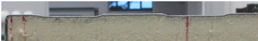
Abb. 4.1: Mikro-Profilierung beim Brucha FP-P 100 Paneel (Profil 1 gemäß [1])
