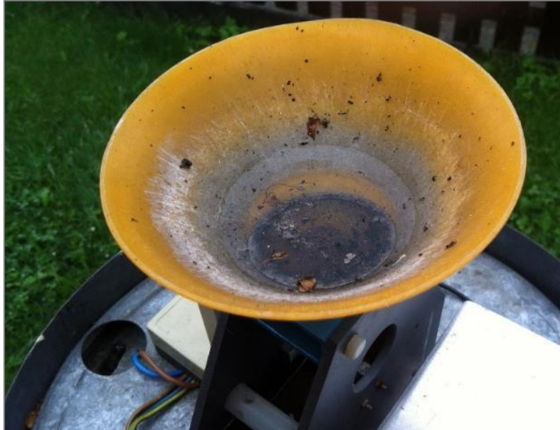
Abbildung 3-5: Durch erhöhten Pollenflug verstopfter Filter der Messstation Leitenbertl
