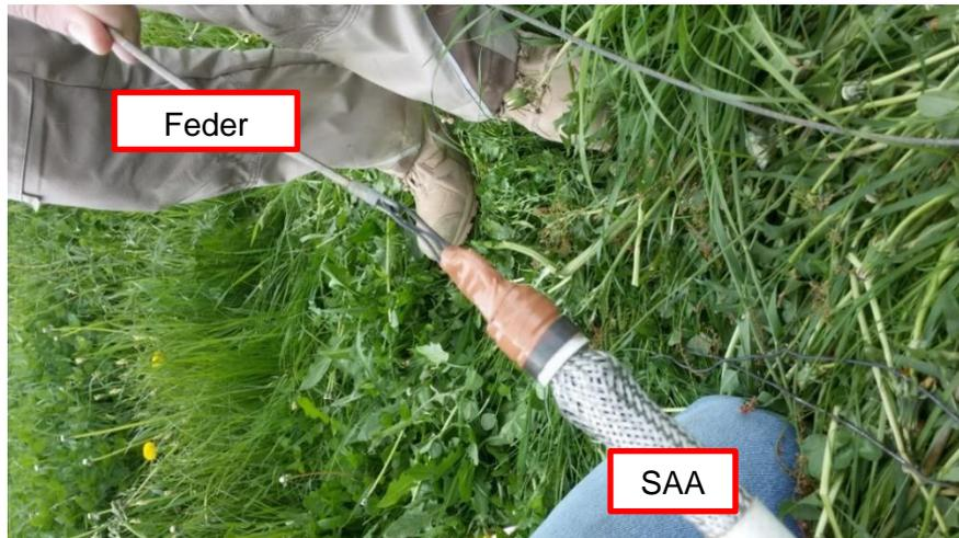
Abb. 44: SAA Messkette verbunden mit der Feder
