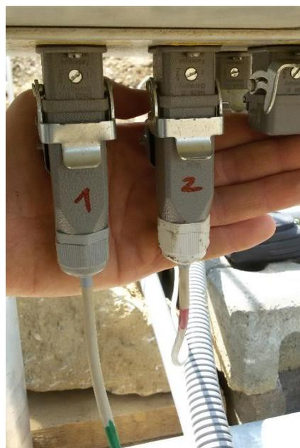
Abb. 61: Anschluss der beiden Messketten an die Bodenstation
