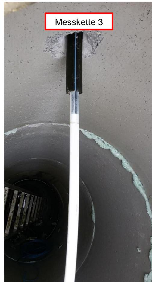
Abb. 65: Schacht 1 - Fixpunkt der Messkette 3
