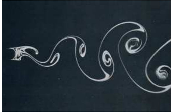
Abb. 2.6 Darstellung der Kármánsche Wirbelstraße [Vgl. The Japan Society of mechanical engineers 1988, S. 10]
