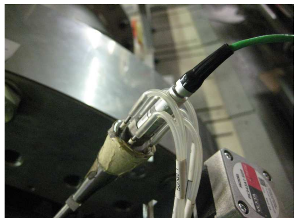
Abb. 4.15 Sonde mit Druck- und Temperaturanschlüsse
