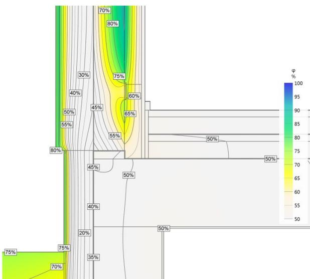
Abbildung 4.31: relative Feuchte  $\phi$  [%] im Detail
