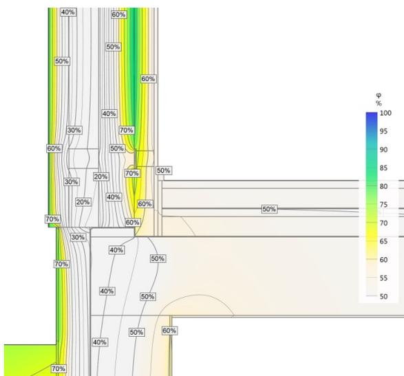
Abbildung 4.12: relative Feuchte  $\varphi$  [%] im Detail
