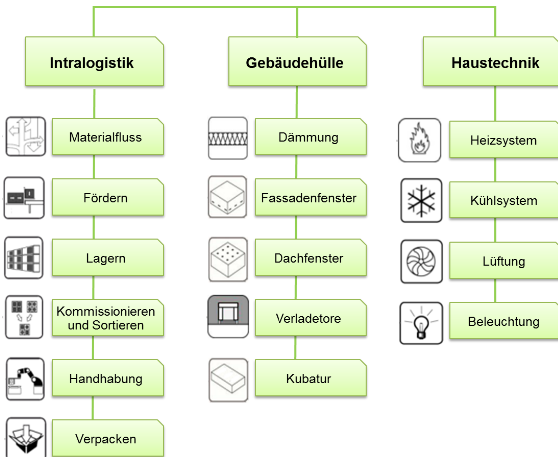
Abbildung 4: Bereiche eines Logistikzentrums (nach [GHFV14], Abb.4.11, S.23)
