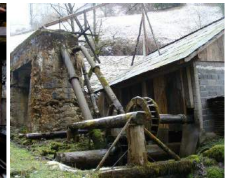
Abb. 32. Schmiede durch Wasser angetrieben
