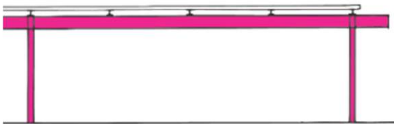
Abbildung 4-41: Binder aus Vollwandprofilen 211
