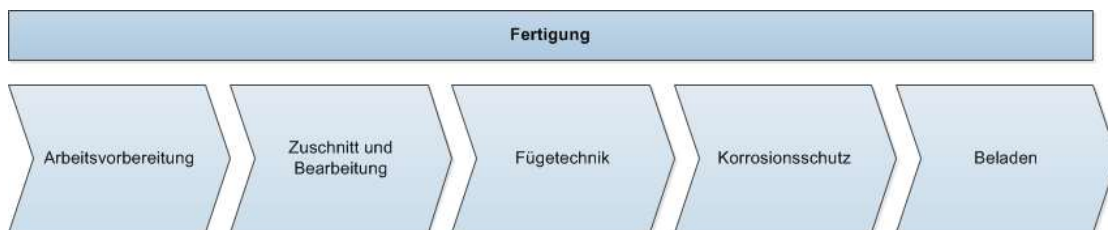
Abbildung 4-12: Herstellung von Stahlkonstruktionen - Fertigung
