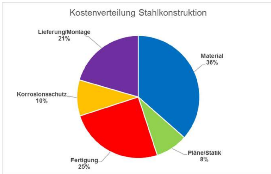
Abbildung 2-10: Kostenverteilung einer Stahlkonstruktion
