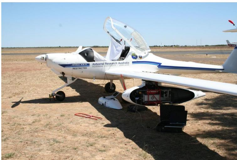
Abbildung 2.2: Flugzeug mit LiDAR-System der Firma RIEGL®
