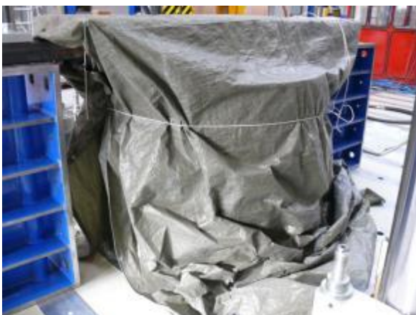
Abb. 260 (li) Abgedeckter Prüfkörper, um zu schnelle Austrocknung zu vermeiden, Rohr t=10 mm; (re) Erhärtete Betonoberfläche des Rohr-Prüfkörpers, Rohr t=10 mm
