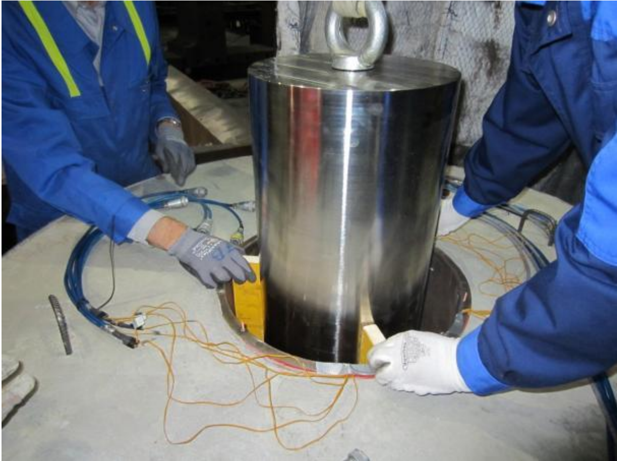
Abb. 268 Einrichten des Lasteinleitungsstempels und Installation der Messeinrichtung im Werk der Fa. Böhler
