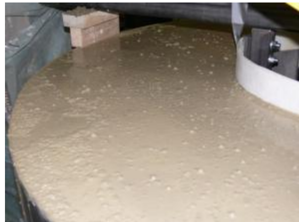
Abb. 259 (li) Eingebrachter Beton, Rohr t=10 mm; (re) fertig betonierter Rohr-Prüfkörper, Rohr t=10 mm
