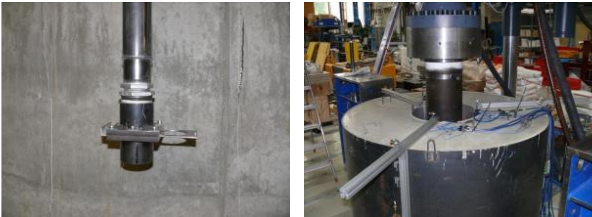
Abb. 262 (li) Rohr für Entleerung des Sandes unter dem Aufspannfeld; (re) Unter der Prüfmaschine eingerichteter Rohr-Prüfkörper, Rohr t=10 mm
