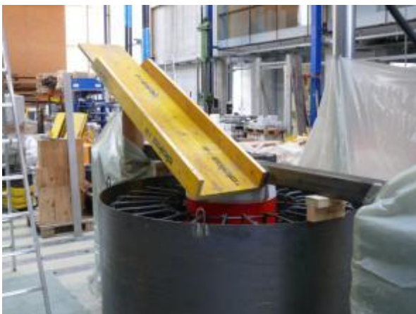
Abb. 257 (li) Betonierfertiger Rohr-Prüfkörper, Rohr t=10 mm; (re) Halterung gegen Verrutschen des Rohres, Rohr t=10 mm
