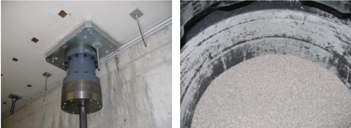
Abb. 261 (li) Untersicht des Aufspannfeldes; (re) Sand zum Einrichten des Rohrprüfkörpers
