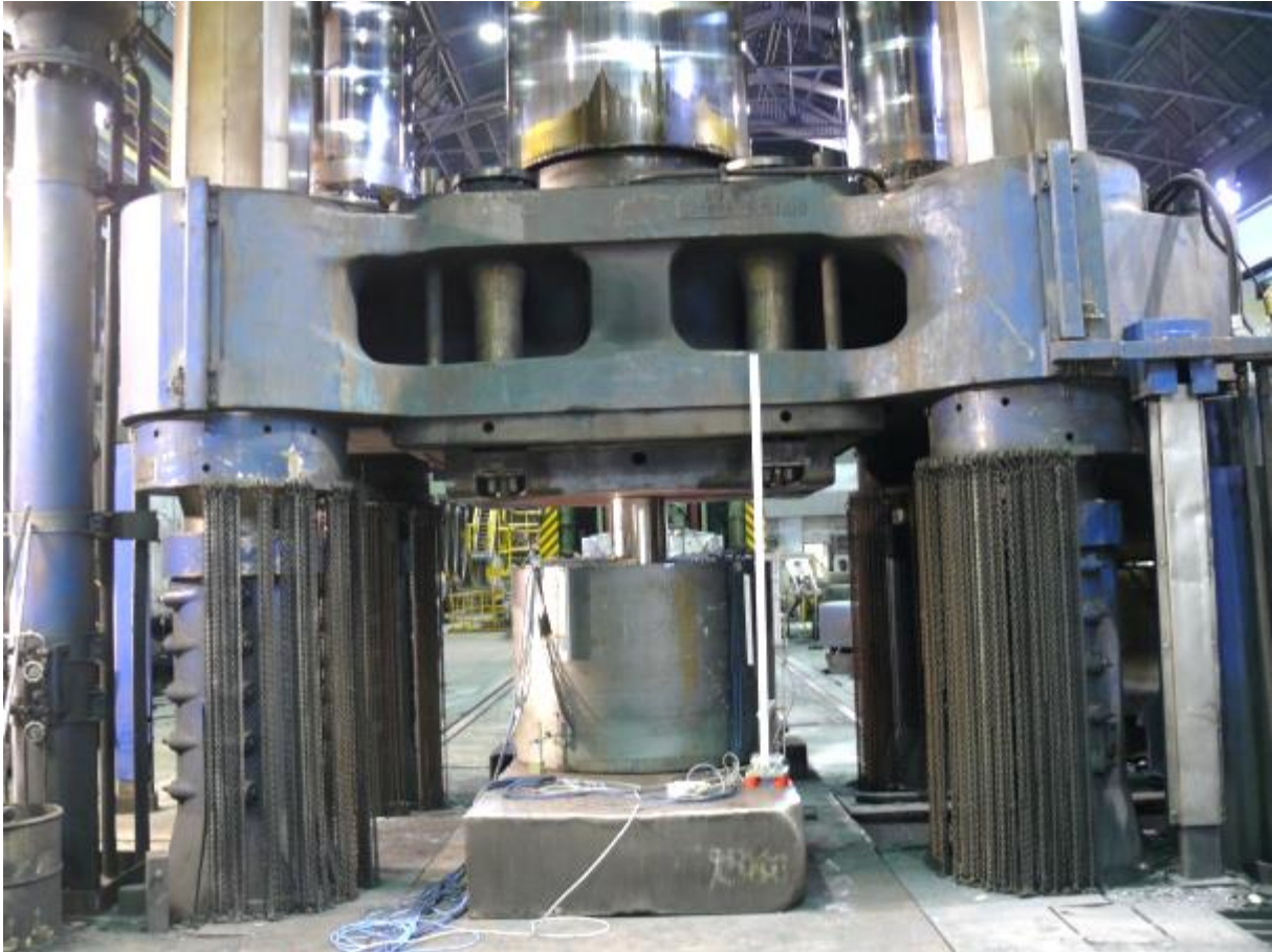
Abb. 281 Prüfgerüst mit Rohr-Prüfkörper im Werk der Fa. Böhler in Kapfenberg; Maximallast 52 MN
