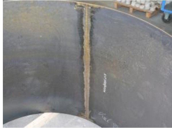
Abb. 255 (li) Abschaltblech an der Außenseite der Prüfkörper; (re) Schweißnaht des Abschaltbleches
