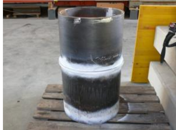
Abb. 252 Anlieferung der Rohre mit aufgeschweißten Schubringen; (li) Rohr t=10 mm, Schubring 82/8; (re) Rohr t=20 mm, Schubring 17/20
