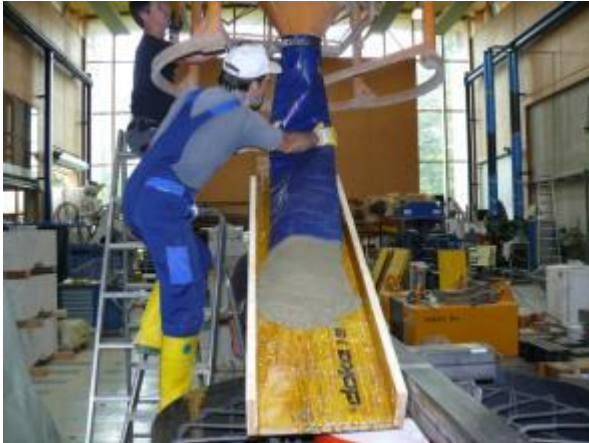
Abb. 258 (li) Einbringen des Betons mittels Kübel und Rutsche, Rohr t=10 mm; (re) Verdichten des Betons mittels Rüttler, Rohr t=10 mm
