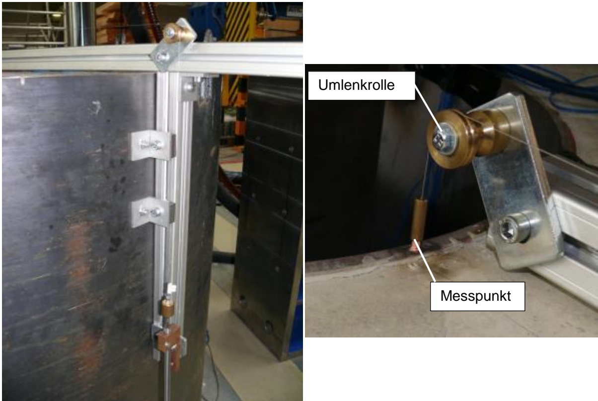
Abb. 264 Details zu den vertikalen Wegaufnehmern – Messung mittels Seilextensometer
