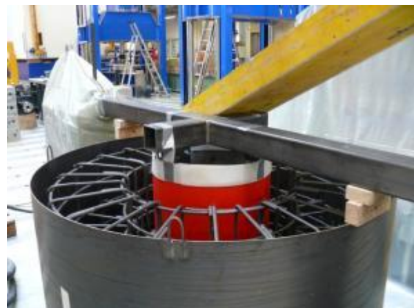
Abb. 257 (li) Betonierfertiger Rohr-Prüfkörper, Rohr t=10 mm; (re) Halterung gegen Verrutschen des Rohres, Rohr t=10 mm
