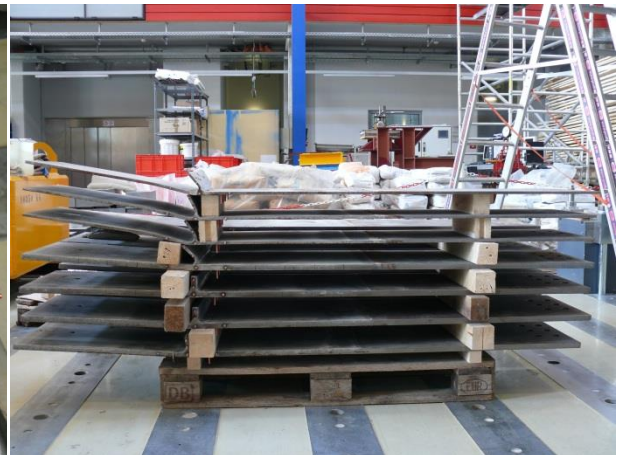
Bild 24 Übersicht der verformten Stahlplatten aus den Labortests
