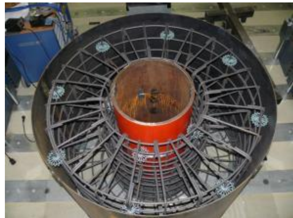
Abb. 256 (li) zusammengesetzter Bewehrungskorb für Rohr t=20 mm; (re) Eingebauter Bewehrungskorb, Rohr t=20 mm
