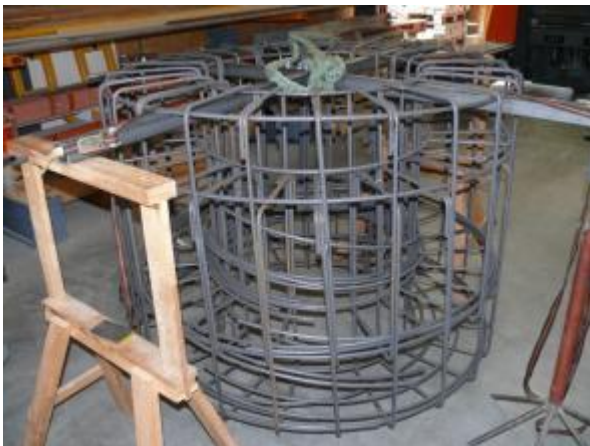
Abb. 256 (li) zusammengesetzter Bewehrungskorb für Rohr t=20 mm; (re) Eingebauter Bewehrungskorb, Rohr t=20 mm
