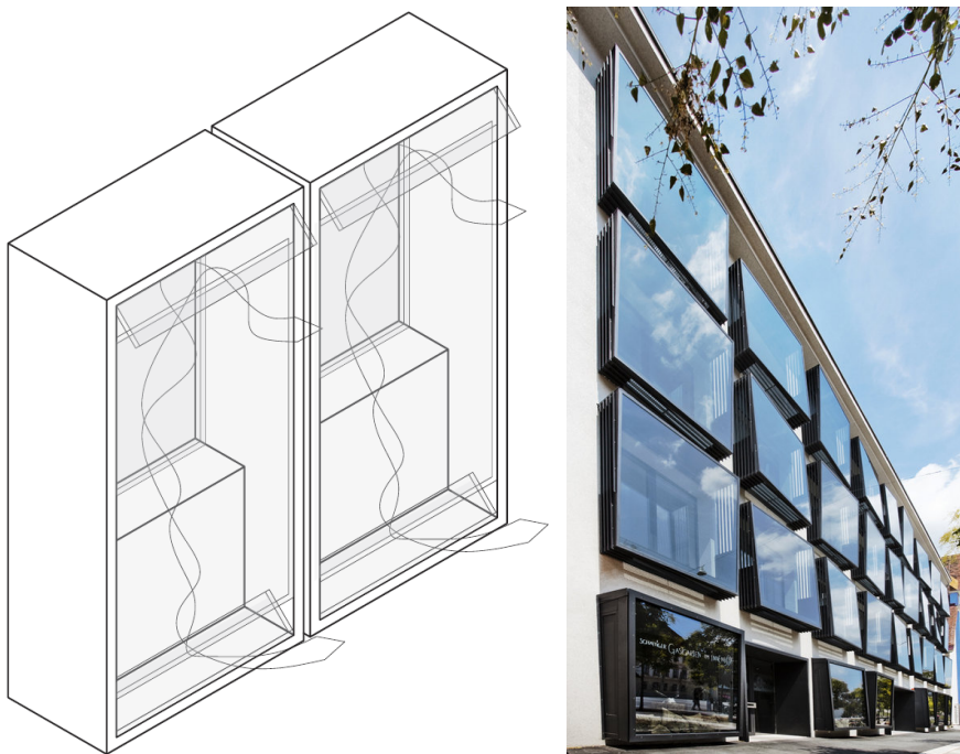
Abbildung 3.1: Schematische Darstellung einer Kastenfensterfassade links [37] sowie ein Ausführungsbeispiel (Karmeliterhof Graz/Österreich) rechts [53]
