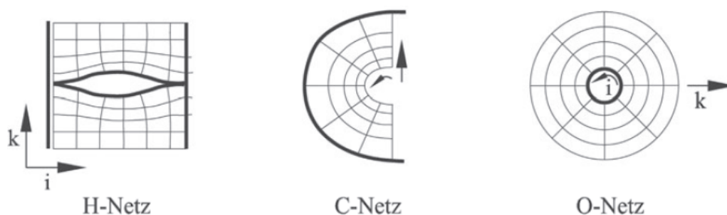
Abbildung 4.10: Topologien für schiefwinklige, strukturierte Rechengitter [38]
