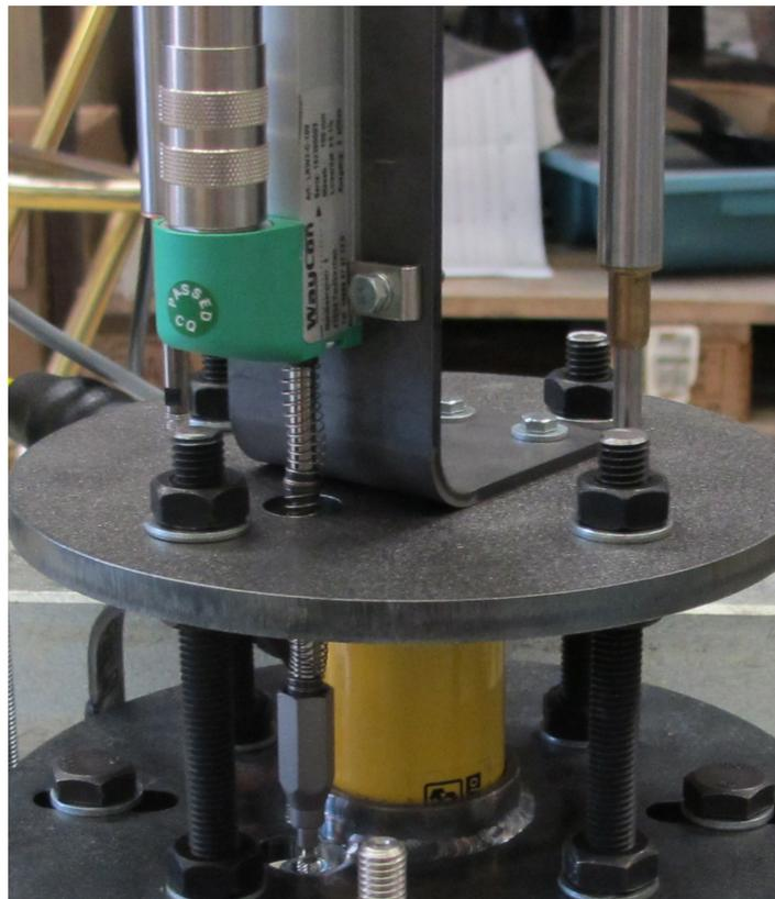
Abbildung 6.2: Auf der Messvorrichtung montierter Wegaufnehmer.
