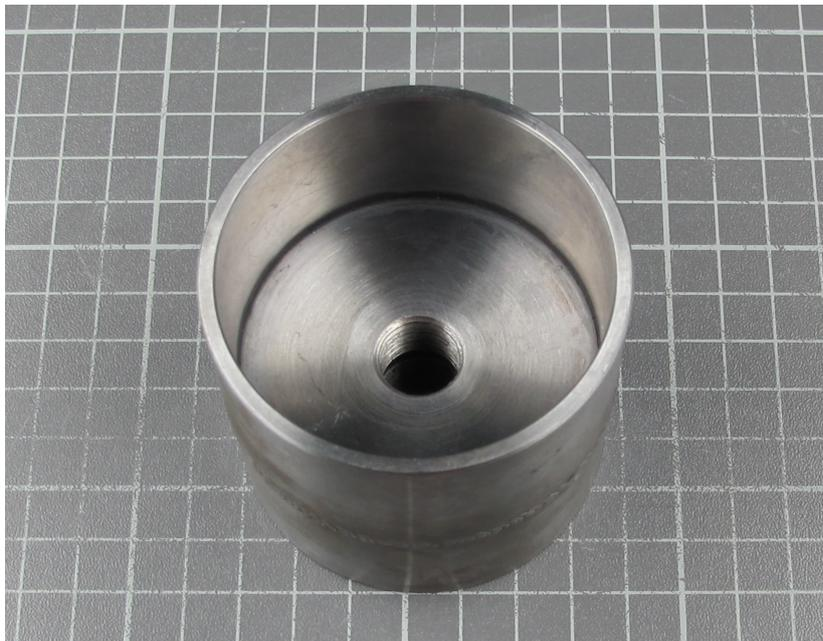
Abbildung 4.3: Lastplatte mit Schutzrohr.
