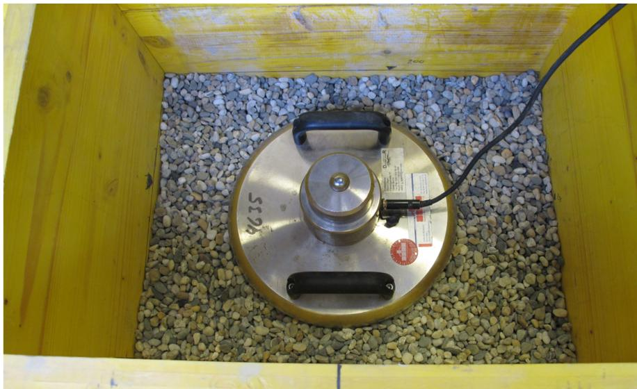
Abbildung 10.3: Lastplatte (300 mm) des LFG in der mit Perlkies 8/11 gefüllten Ringraum-Box.
