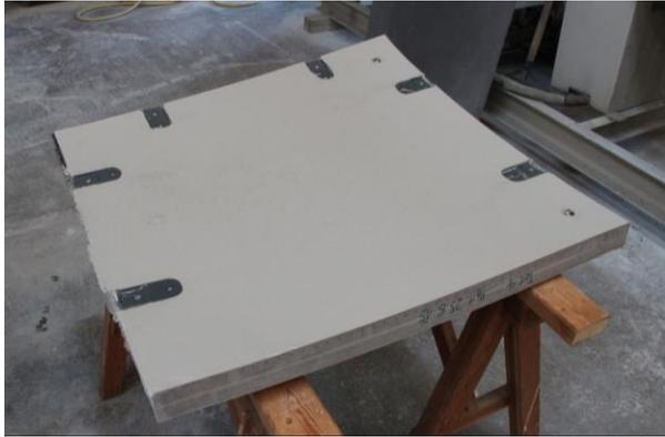
Abbildung F.11 Ausschaltetes Fertigteil, noch mit Aussparungskörpern.
