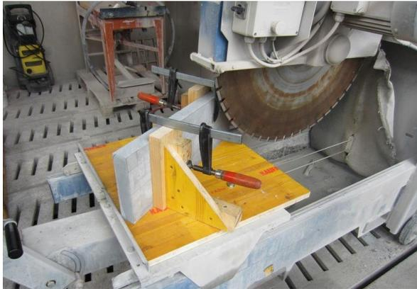
Abbildung 4.22 Schräger Trennschnitt zur Herstellung der beiden Fügeiteile
