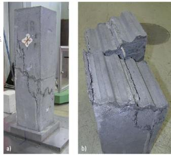
Abbildung 2.14 Untersuchungen von feinprofilierten, im Match-Cast-Verfahren hergestellten Trockenfugen; aus [Oettel & Empelmann 2013]
