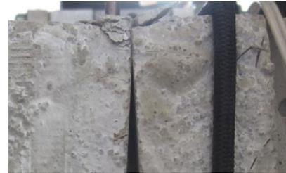
*Abbildung 4.90 Abplatzungen und Rissbildung in der Biegedruckzone, Proben B-01, B-02 und B-03 (v.l.n.r.)*
