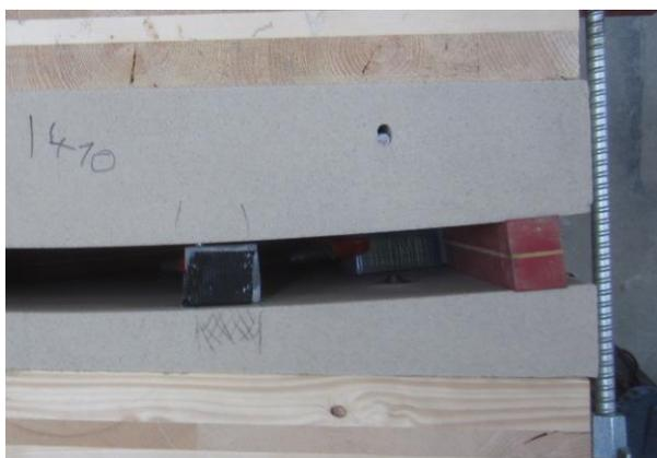
Abbildung F.7 Aussparungskörper bei geschlossener Schalung. Draufsicht auf die Einfüllseite
