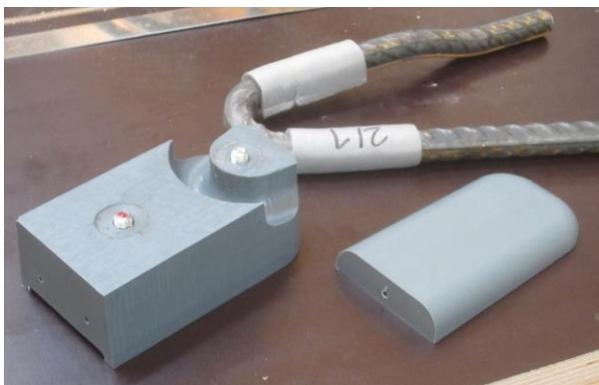
Abbildung F.3 Zweiteiliger Aussparungskörper zur Befestigung des Verbundankers an der Schalung
