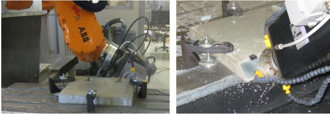
Abbildung 4.43 Schleifen der Probekörper mittels Industrieroboter
