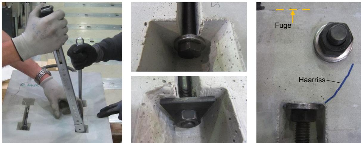
Abbildung 4.44 Fügen der Proben: Anspannen (Typ 2, SF), Variation der Beilage SF – CF (Typ 2), Haarrisse nach dem Anspannen (Typ 1, SF)
