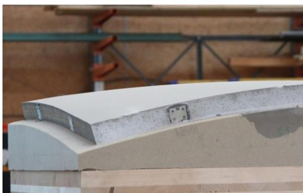
Abbildung F.9 Ausgehärtetes Fertigteil nach Abnahme der Schalungs-Oberseite und der Randabschalung. Die Aussparungskörper sind noch mit den Befestigungswinkeln verschraubt.
