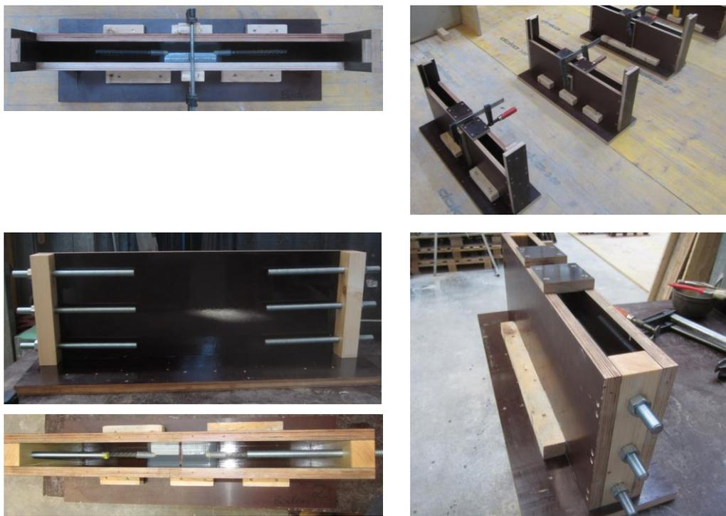
Abbildung 4.77 Schalungen der Versuchskörper Serie 2; Biegeversuche (oben) und Zugversuche (unten)
