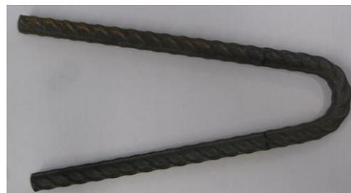
Abbildung 4.75 Ankerbügel
