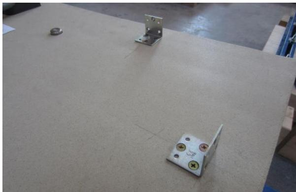
Abbildung F.5 Auf der Formsandschalung montierte Befestigungswinkel. Die Positionen wurden von den drei Referenzpunkten aus gemessen (einer davon ist links oben im Bild sichtbar)
