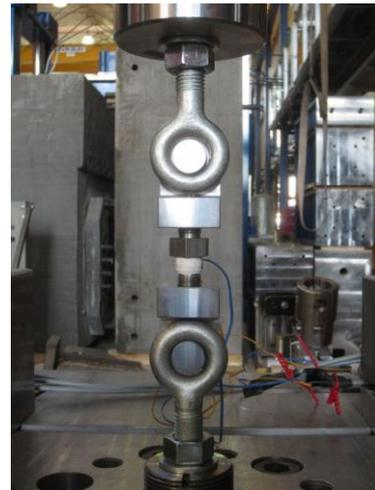
Abbildung 4.84 Mit DMS bestückte Spannschraube zur Kraftmessung (links), Kalibrierung (rechts)
