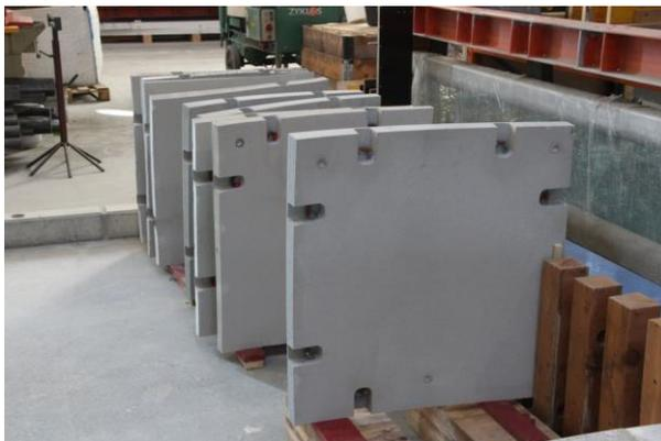
Abbildung F.15 Einzelne Fertigteile vor der Montage; An der Platte im Vordergrund werden die weiteren Elemente angefügt
