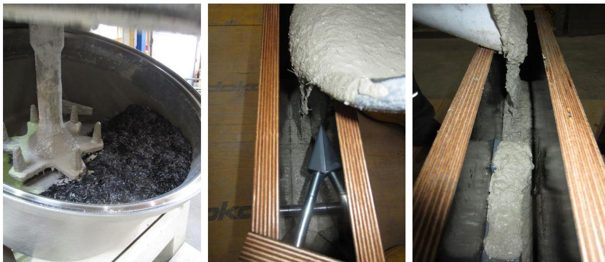
Abbildung 4.42 Betonage der Probekörper, v.l.n.r.: Karbonfaserzugabe im Mischer (M2CF), Befüllung Probe Typ 1 (M1SF), Befüllung Probe Typ 2 (M3CF)
