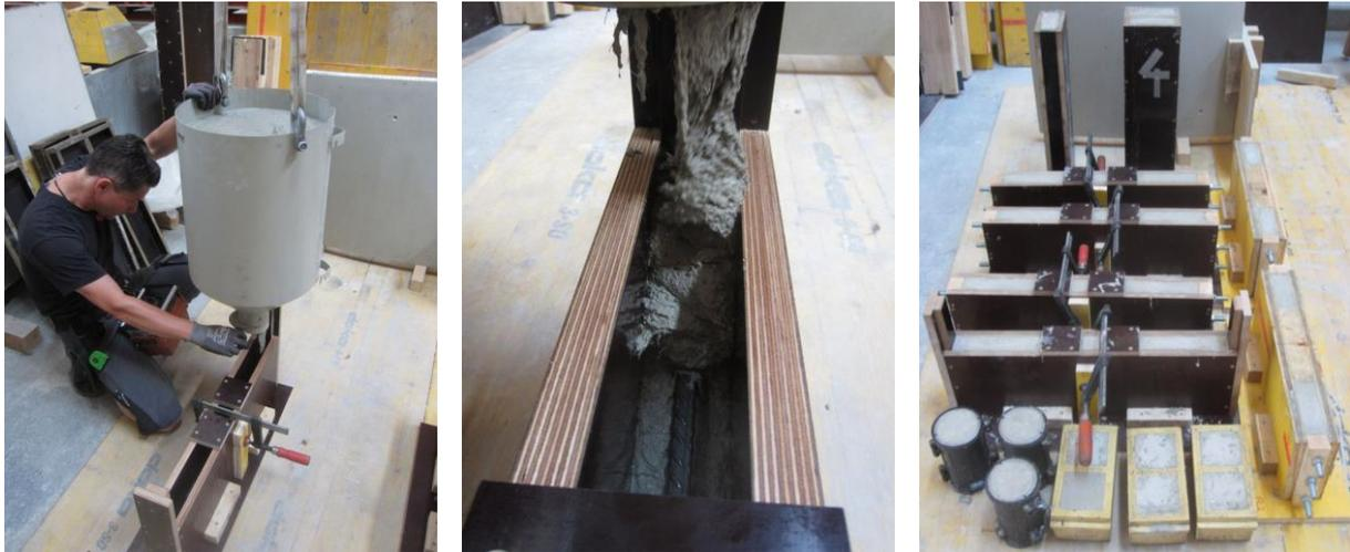
Abbildung 4.78 Betonage Versuchsserie 2; Befüllen eines Probekörpers (li., mi., M5SF) und abgeschlossene Betonage (re., M6SF)
