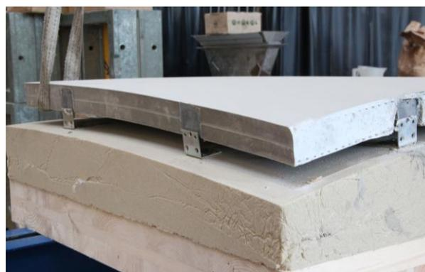
Abbildung F.10 Abheben des Fertigteils von der Schalungs-Unterseite nach der Entfernung der Befestigungsschrauben.
