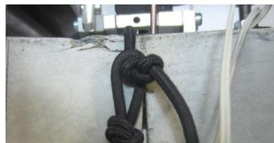
*Abbildung 4.91 Druck-Schub-Bruch in der Biegedruckzone, Proben B-04 und B-05 (v.l.n.r.)*
