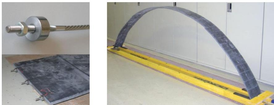
Abbildung 2.31 Verbindung durch Vorspannung nach [Burtscher et al. 2008]; Spannglied und Probekörper für Biegeversuche, Modellbogen
