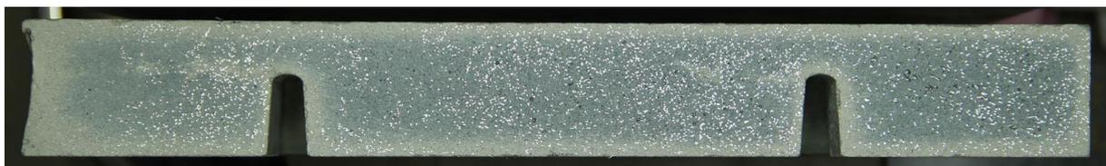
Abbildung 4.47 Schnittflächenfotografie der Probe M1SF\_T2\_B-02 mit deutlich erkennbaren, abgesunkenen Fasern (Oberseite bzw. Befüllseite links)
