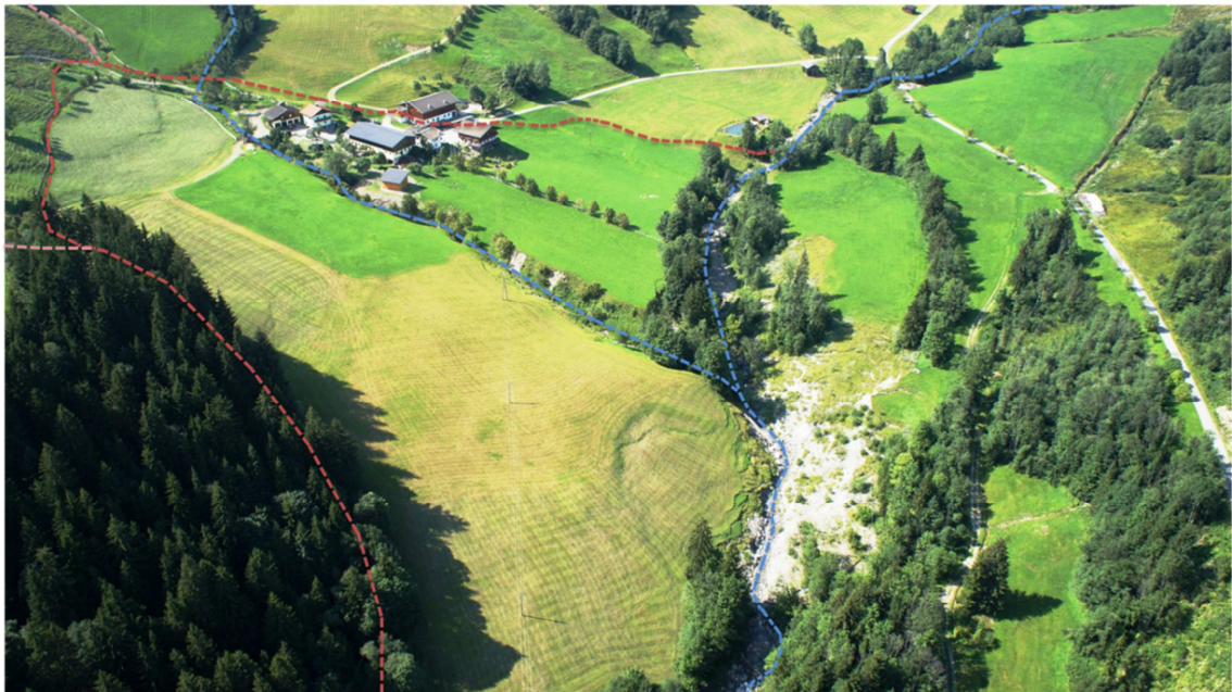
Abbildung 2-14: Untersuchungsgebiet mit vermuteter Rutschungsbegrenzung (dunkelrot strichliert) 27
