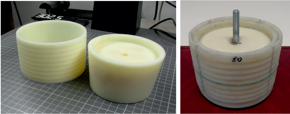
Abbildung 6.7: Verspannmechanismus - links: Spannschale vor der Überarbeitung; rechts: Zusammengebauter Spannmechanismus nach der Bearbeitung der Schale, zusammengehalten durch ein Gummiband
