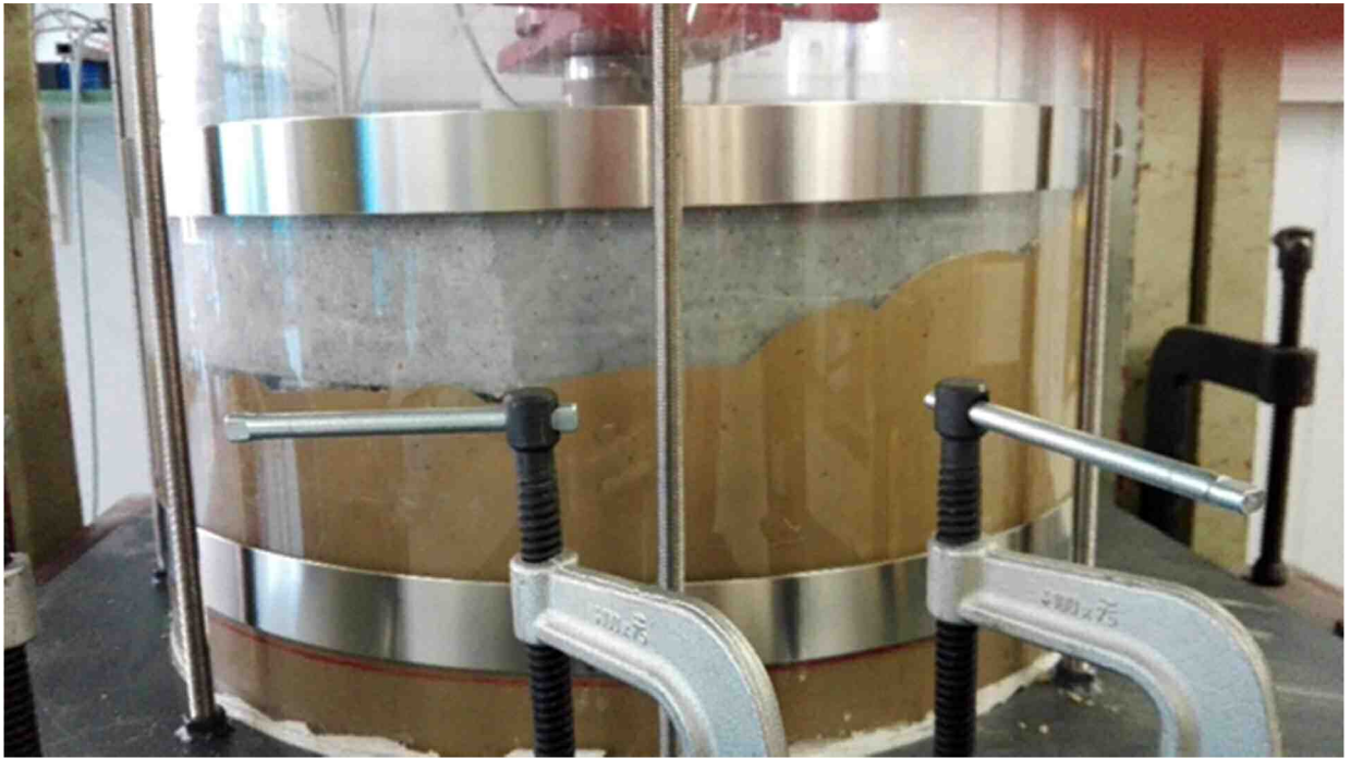
Abb. 56 Seitlicher Austritt des Versuchsbodens während der dynamischen Belastung
