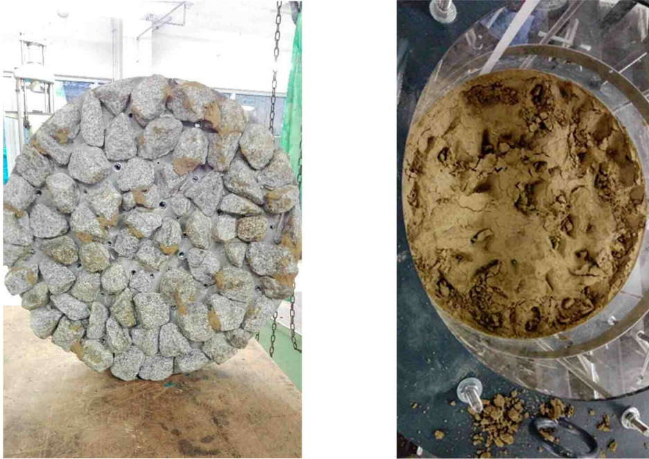
Abb. 49 Kopfplatte nach dem Ausbau (links), Oberfläche des Versuchsbodens nach dem Versuch (rechts)
