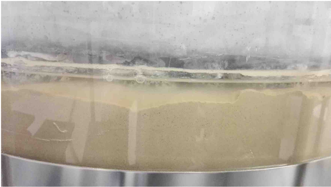
Abb. 69 Aufsteigende Feinteile nach ca. 1000 Lastwechseln
