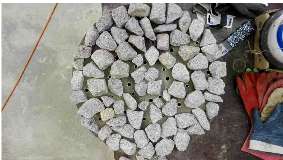
Abb. 29 UHPC Kopfplatte mit aufgebrachtem Gleisschotter (frontal)
