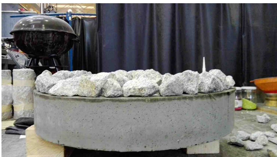
Abb. 29 UHPC Kopfplatte mit aufgebrachtem Gleisschotter (frontal)
