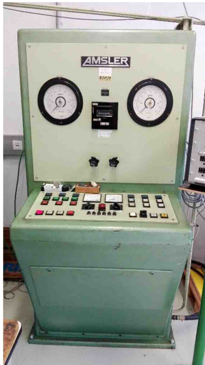
Abb. 35 Hydraulischer Pulser Amsler P960
