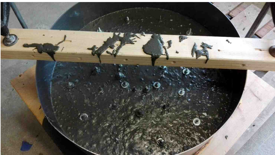
Abb. 28 Eingegossener UHPC mit Elefantenhaut
