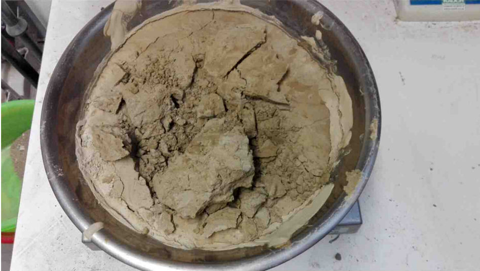
Abb. 38 Versuchsboden im trockenem Zustand
