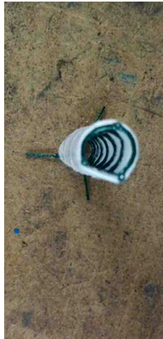
Abb. 50 Sauberer Schmutzfänger (Typ C) nach dem Ausbau
