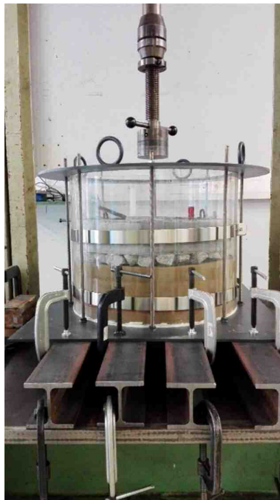
Abb. 43 Prüfgehäuse im dynamischen Prüfstand
