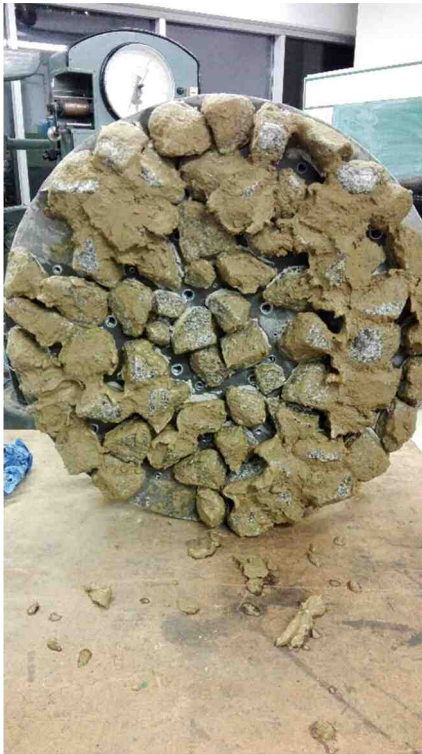
Abb. 68 UHPC Kopfplatte nach dem Ausbau (links), Schlamm zwischen den Steinen (rechts)
