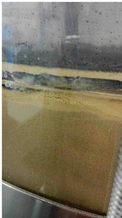
Abb. 70 Hochpumpen von Feinteilen zwischen den Steinen
