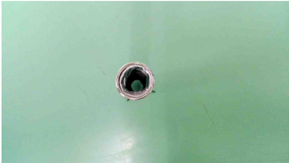
Abb. 24 Eingebauter Drahtkörper in der Hülse Bsp. 1,4 cm
