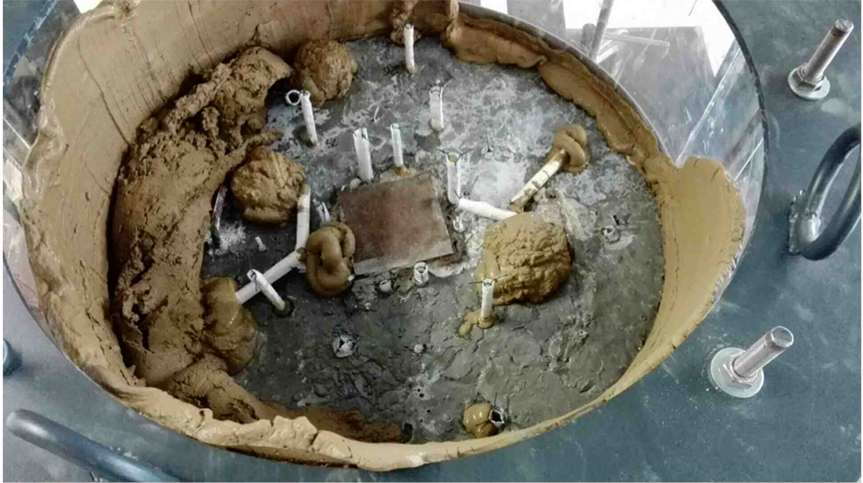
Abb. 58 Zustand des Versuchsaufbaus nach 2000 Lastwechseln
