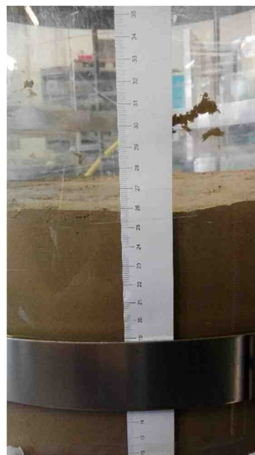
Abb. 41 Lageweise eingebauter Versuchsboden
