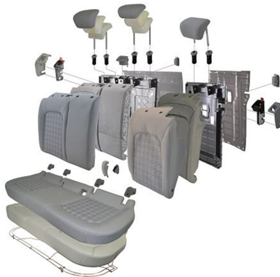
Abbildung 27: Aufbau der Rückbank (BMW 118i). 121
