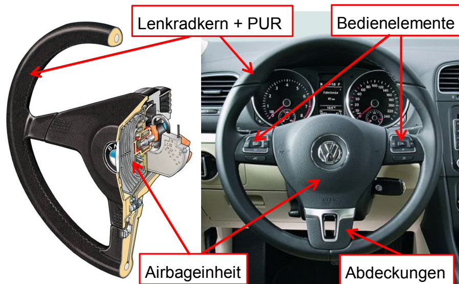
Abbildung 24: Links: Aufbau eines Lenkrades 115 und rechts: Lenkrad des VW Golf VI 2009. 116
