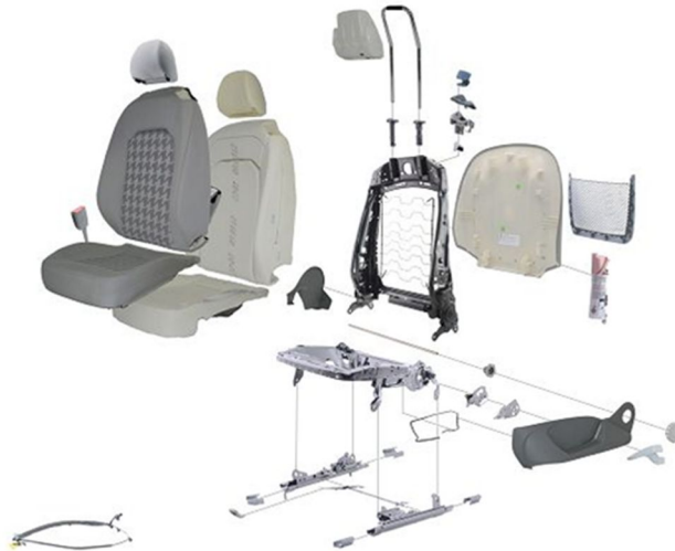
Abbildung 26: Aufbau des Fahrersitzes (Audi A3 1.4 TFSi Attraction). 120
