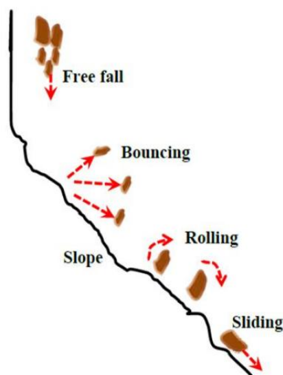
Abbildung 2-5: Mögliche Bewegungsmechanismen während eines Steinschlages, (Basson, 2012).
