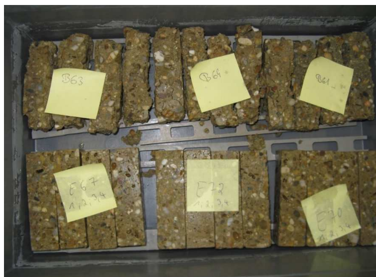
Abb.: 4.6: B6-Betone – Optischer Vergleich des Zerstörungsgrades mit den IXAT-Betonen
