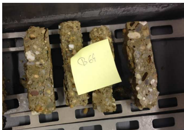
Abb.4.4: B64 (Standardbeton 100- C 3 A-freier Zement)
