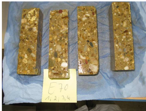
Abb.4.14: E70 (50- nicht C 3 A-freier Zement 42,5-Hüs; 7,5- inerter Kalksteinmehl-Mikrofüller 165)
