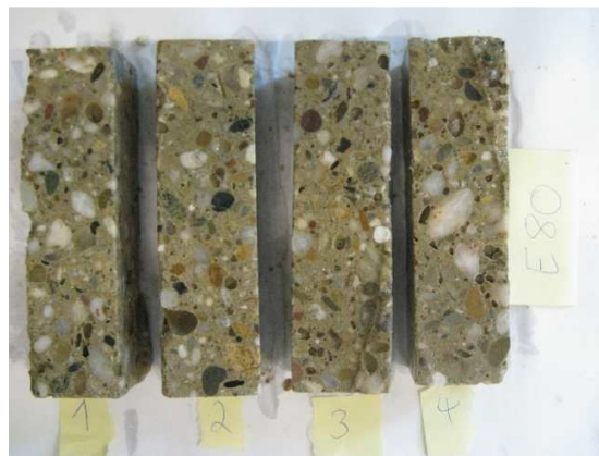
Abb.4.20: E80 (50- nicht C 3 A-freier Zement; 42,5-Hüs; 7,5-inerter Quarzmehl-Mikrofüller 213)
