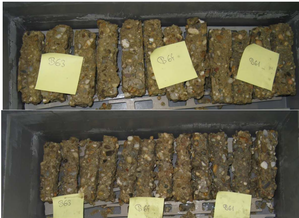
Abb.4.5: B6-Betone – vor (oben) und nach (unten) dem Bürsten
