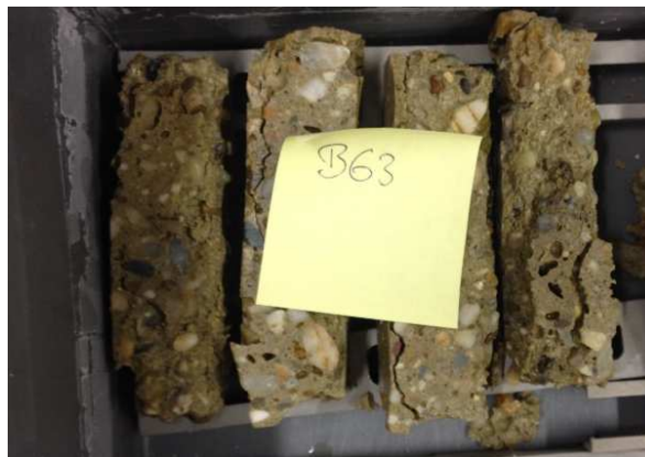
Abb.4.3: B63 (55- nicht C 3 A-freier Zement; 30-Hüs; 10-inertes Kalksteinmehl; 5-inerter Kalkstein-MF 165)
