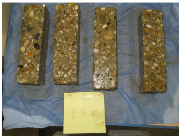
Abb.4.15: E71 (40 - nicht C 3 A-freier Zement; 42,5-Hüs; 10-inerter Kalksteinmehl-Ecofüller; 7,5-hydraulisch wirksames Mikrosilika)
