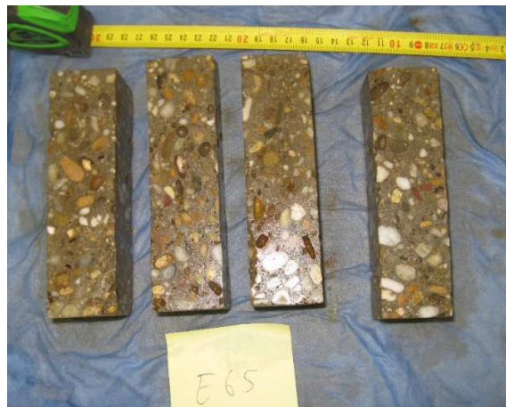
Abb.4.9: E65 (Standardbeton 82-C 3 A-freier Zement; 18-AHWZ)
