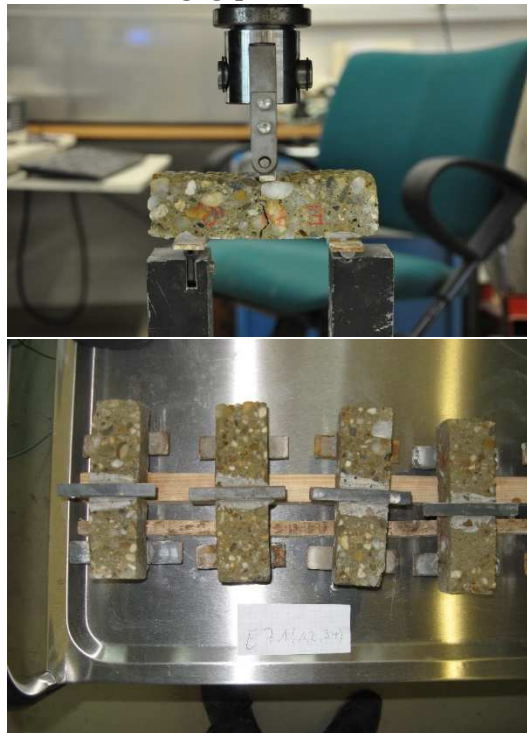
Abb.3.9: Biegezugversuch (oben) und gegipste Prüfkörper (unten)
