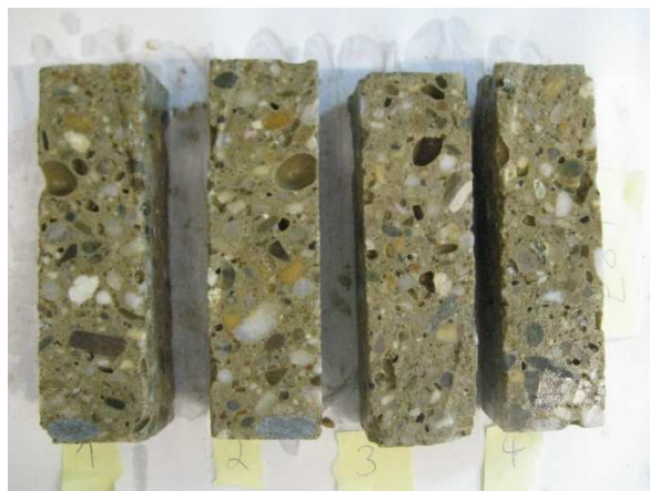
Abb.4.21: E81 (40- nicht C 3 A-freier Zement; 42,5-Hüs; 10-inerter Kalksteinmehl-Ecofüller; 7,5 – Zeolith-MF)
