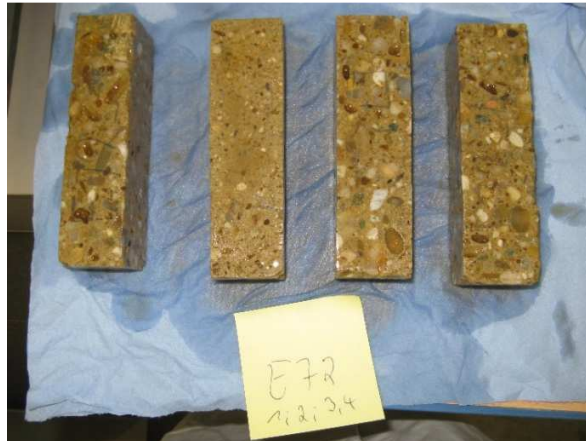
Abb.4.16: E72 (60-C 3 A-freier Zement; 32,5-Hüs; 7,5-inerter Quarzmehl-Mikrofüller 213)
