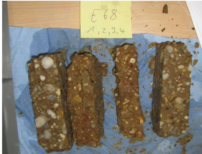
Abb.4.11 E68 (Vergleichsbeton 100- nicht C 3 A-freier Zement mit LPB)
