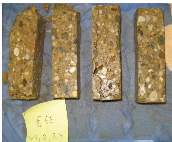
Abb.4.10: E66 (Vergleichsbeton 100-C 3 A-freier Zement)
