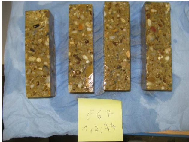
Abb.4.13: E67 (60-C 3 A-freier Zement; 32,5-Hüs; 7,5-inerter Kalksteinmehl-Mikrofüller 165)
