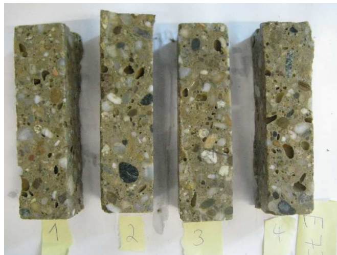
Abb.4.17: E73 (40- nicht C 3 A-freier Zement; 42,5-Hüs; 10-inerter Kalksteinmehl-EF; 7,5 - inerter Kalksteinmehl-MF 165)
