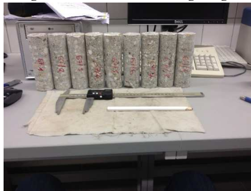
Abb.3.12: Prüfkörper des SVA-Verfahren
