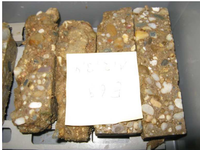
Abb.4.12: E69 (Vergleichsbeton 100 - nicht C 3 A-freier Zement (ohne LPB))
