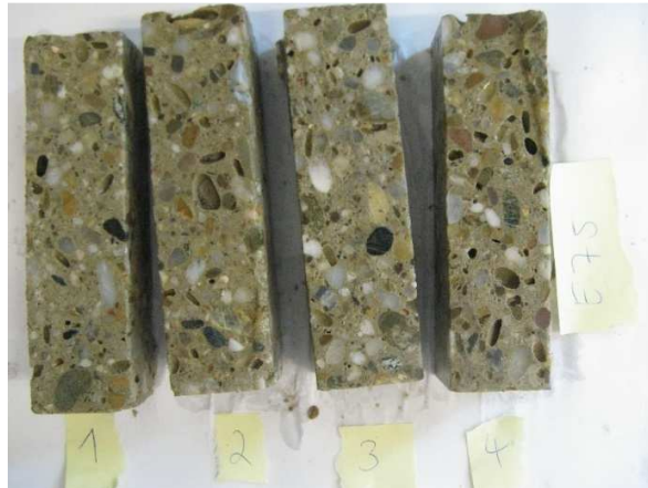
Abb.4.19: E75 (40- nicht C 3 A-freier Zement, 42,5-Hüs; 10-inerter Kalksteinmehl-Ecofüller; 7,5 – Metakaolin)
