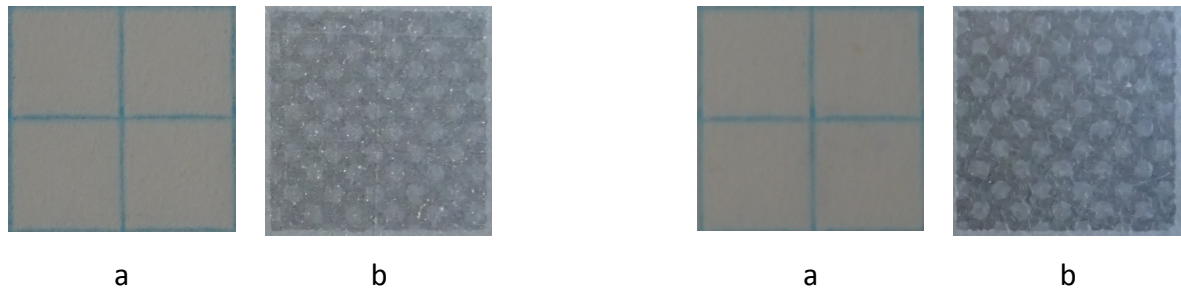
Abbildung 20 - Hergestellte PLA-Folien nach dem Verarbeitungsverfahren 3, links: PLA+Biozid, rechts: reines PLA; a: Folie auf weißem Untergrund, b: Folie auf schwarzem Untergrund; Aufnahme: 1 cm 2 3-fach vergrößert
