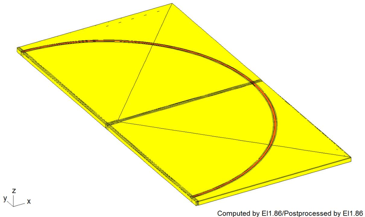
Abbildung 3.9: FEM-Modell der Schleifenantenne.
