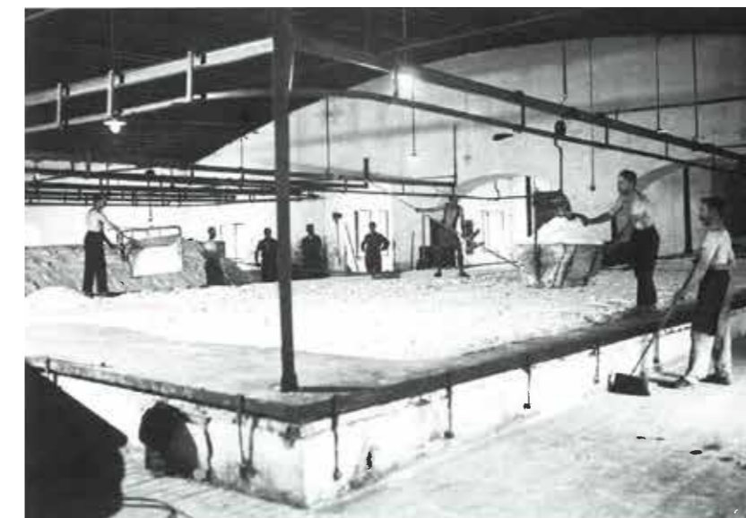
Abb. 60 Trocknen des Salzes. An jede der vier Pfannen der neuen Saline war eine Salzdarre angeschlossen. Diese wurde durch die heißen Rauchgase der Sudpfannenfeuerungsanlage erwärmt.
