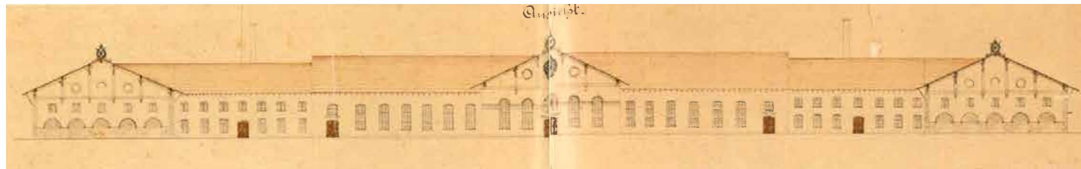
Abb. 113 Ansicht der neue Saline, welche nach den Plänen von Architekt Franz Ritter von Schwind 1854-1862 erbaut wurde. Sie war ursprünglich 182,4 Meter lang und 66,5 Meter breit. Zwei Haupttrakte beherbergten vier Sudpfannen und Dörrstätten. Verbunden waren sie durch drei Quertrakte. Im Norden und Süden waren je ein Salzmagazin angeschlossen. Auf der nebenstehenden Abb. 04 gut erkennbar ist das offene Erdgeschoß mit seinen Arkaden beim vorspringenden Teil des Magazins (heute geschlossen).
