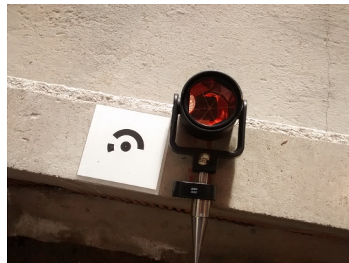
(b) Rundprisma mit Minilotstock
