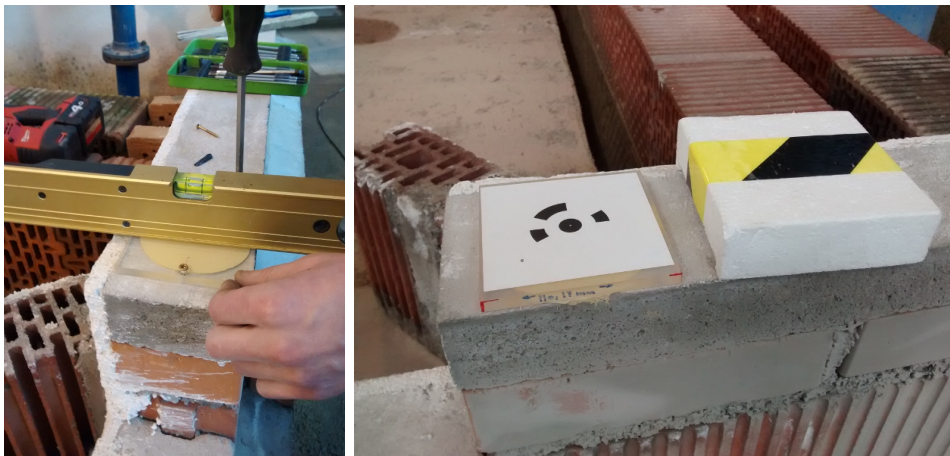
Abbildung 4.1: Ortsfeste Montage GCP r_i = 7 \text{ mm} auf PMMA-Platte 110 \text{ mm} \times 110 \text{ mm} \times 11 \text{ mm}
