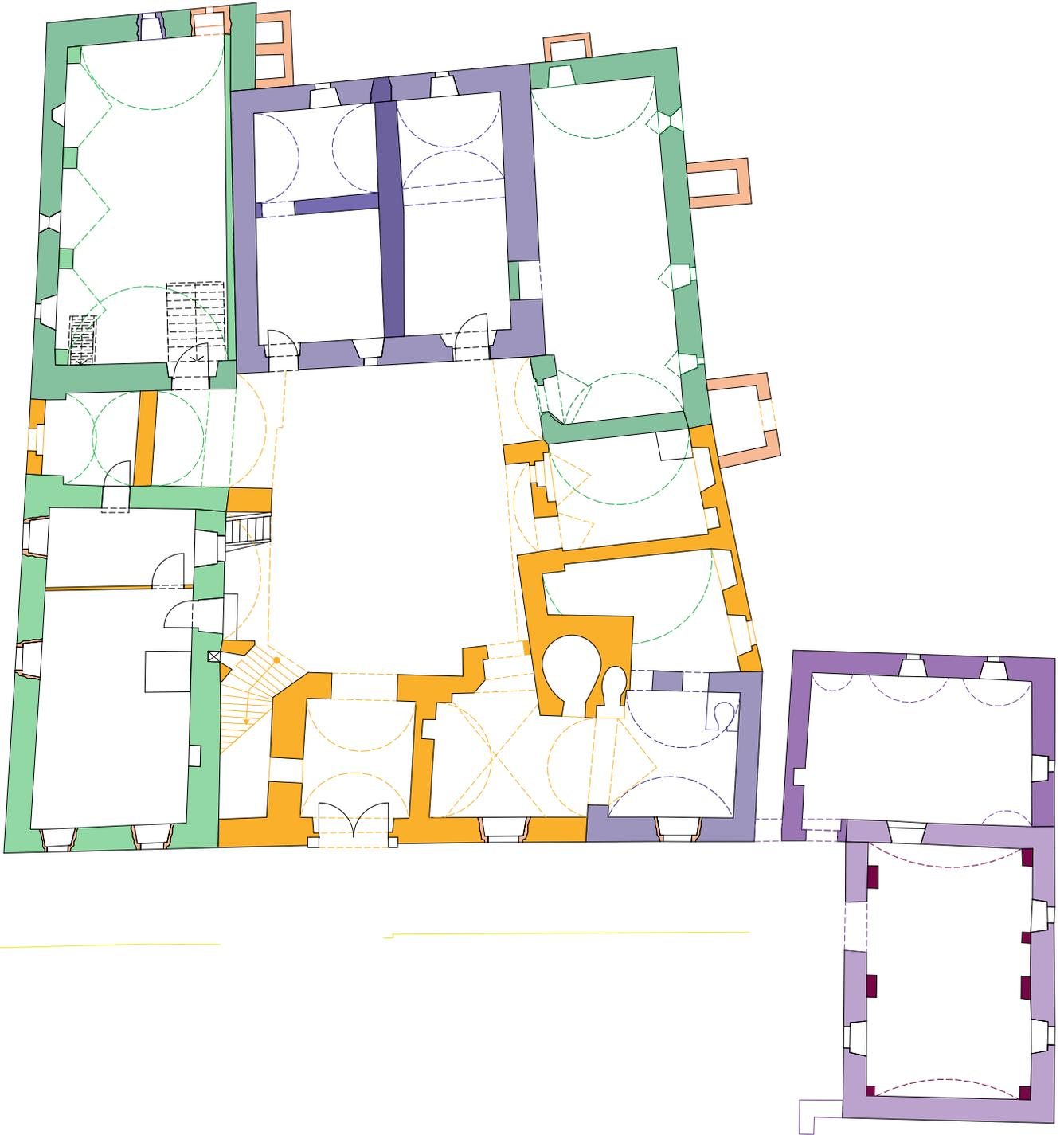
Abb.502. Baualterplan Erdgeschoss; M1:200
