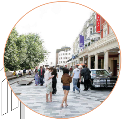
Abb. 43: Der Wegfall des Bordsteines ermöglicht eine schwellenlose Benutzung.
