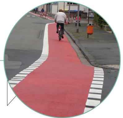
Abb. 34: Wenn das Befahren gegen die Einbahnstraße mit dem Fahrrad erlaubt ist, wird durch einen farblich markierten Fahrradstreifen mehr Aufmerksamkeit bei den anderen Verkehrsteilnehmern erzeugt.
