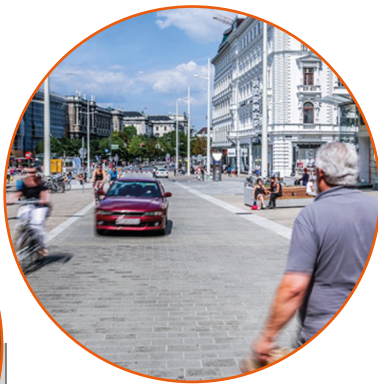
Abb. 37: Ein markantes Merkmal der „Shared Street“ äußert sich durch den Wegfall des Bürgersteiges. Somit wird die Priorität des Fußgängers betont. Um allerdings Unklarheiten vorzubeugen, werden die einzelnen Bereiche mit unterschiedlichen Materialien, wie auch farblichen Akzentuierungen voneinander unterschieden.
