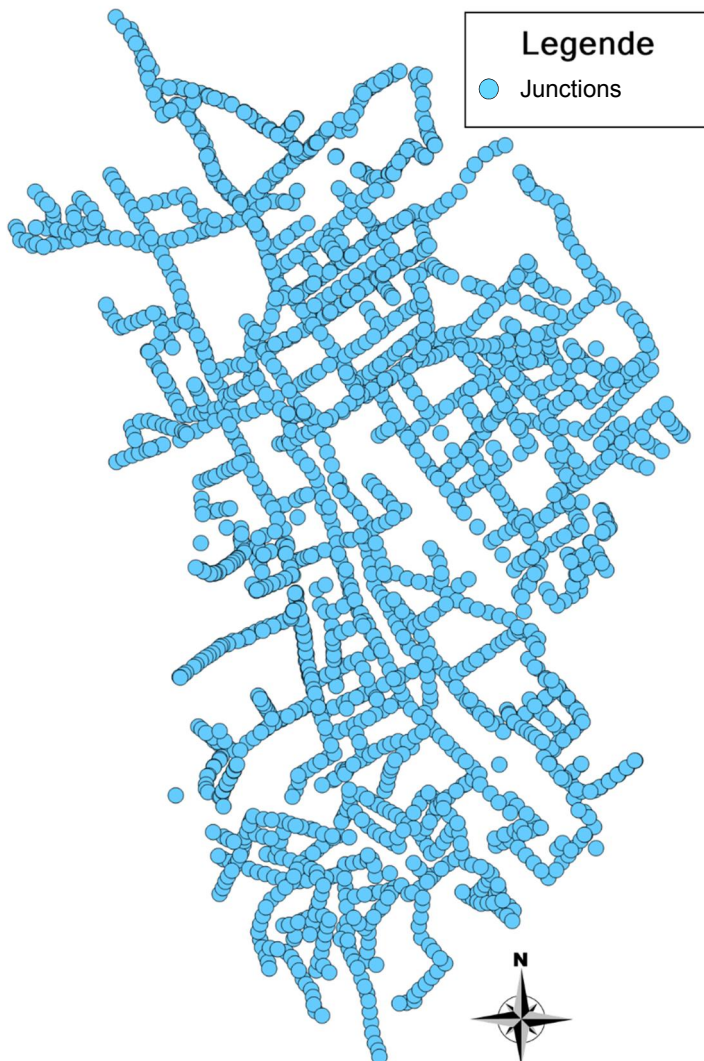
Abbildung 3-9: Junctions des fertigen Weizer Kanalnetzmodells
