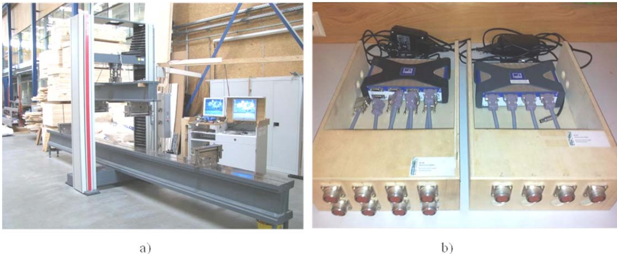
Abbildung 4.12: a) Universalprüfmaschine; b) Messverstärker QuantumX MX840A und MX410A [41]
