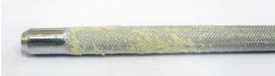
Abbildung 4.13: Holzfaser in rauer Oberfläche nach der Prüfung
