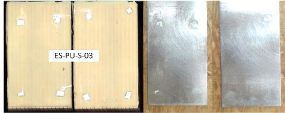
ES-PU-S-Q-01 („d“) F_{\max} = 6,8 \text{ kN}
