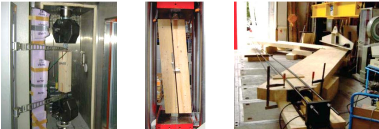
Abbildung 5.15: Zugversuche unter Temperaturbeanspruchung (links), Druckscherversuche (Mitte), Rahmeneckenversuche (rechts) [9]
