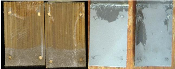
S5- COQ -SA-03 F_{\max} = 49,4 \text{ kN} Bruch = oben
