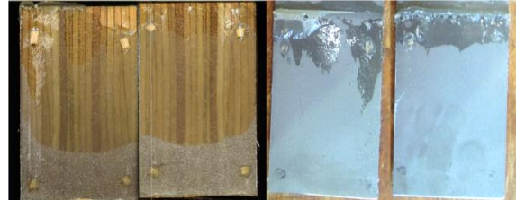
S5- COQ -SA-02 F_{\max} = 55,5 \text{ kN} Bruch = oben
