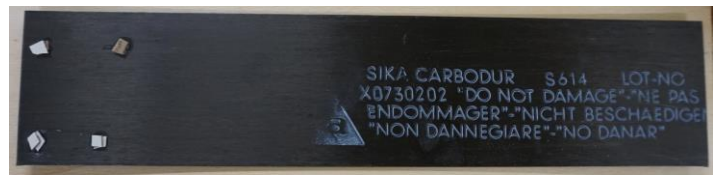
Abbildung 7.6: Kohlefaserlamelle des Typs S614 vor dem Einkleben
