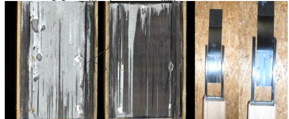
SL-SD-QQ-01 („a“) F_{\max} = 53,9 \text{ kN}
