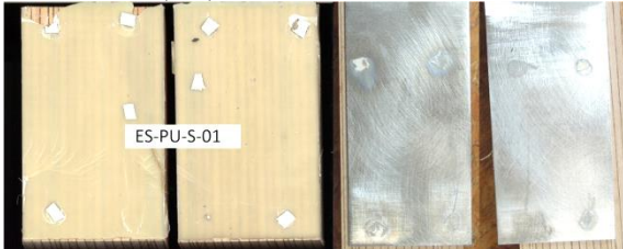
ES-PU-S-Z-01 („b“) F_{\max} = 28,5 \text{ kN}
