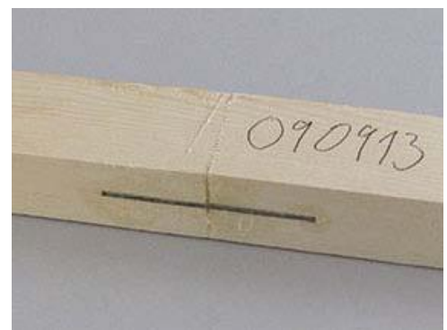
Abbildung 5.22: Prüfkörper mit eingeklebten Lochblechen [91]
