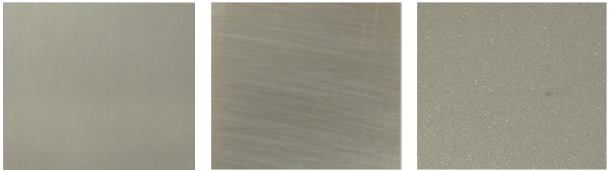
Abbildung 7.3: Oberflächenbehandlungen des Edelstahl: blank, geschliffen und sandgestrahlt (von links nach rechts)
