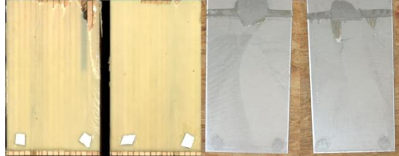
ES-PU-S-03 („c“) F_{\max} = 16,2 \text{ kN}
