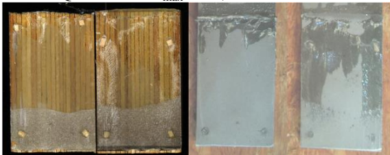
S5- COQ -SA-05 F_{\max} = 56,5 \text{ kN} Bruch = unten
