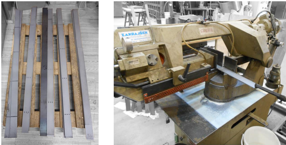
Abbildung 7.8: Blechstreifen von Stahlblech S 760 MC (links) und Metallbandsäge (rechts)
