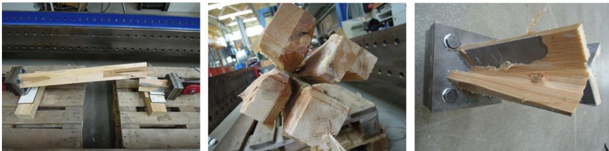
Abbildung 5.24: Versagen des Prüfkörpers durch unzureichende Haftung zwischen Klebstoff und Stahl [52]
