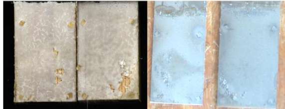
S5D-HB-SA-10 F_{\max} = 23,6 \text{ kN} Bruch = oben
