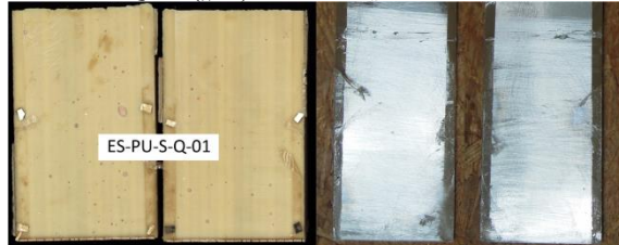
ES-PU-SA-Q-01 („c“) F_{\max} = 22,6 \text{ kN}
