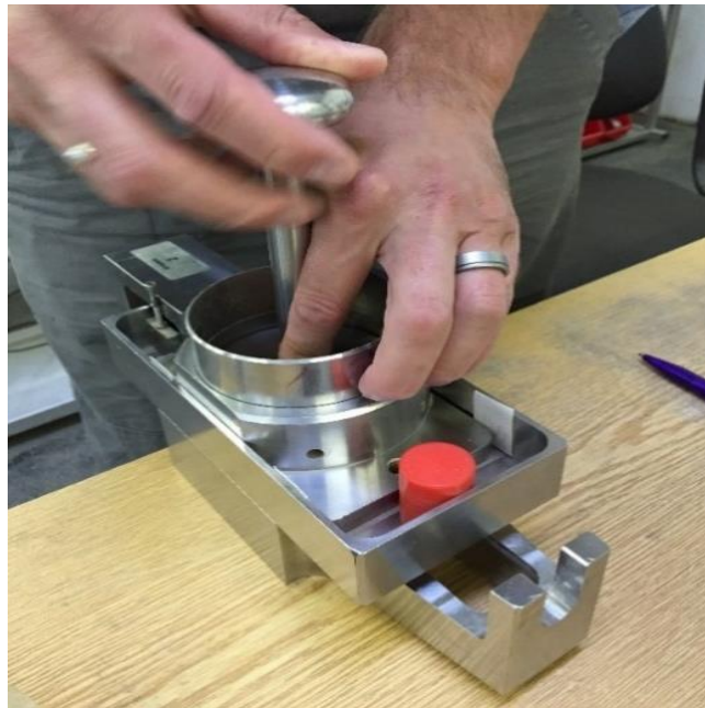
Abb. 26: Einbau der Bodenprobe in die Rahmenscherbox
