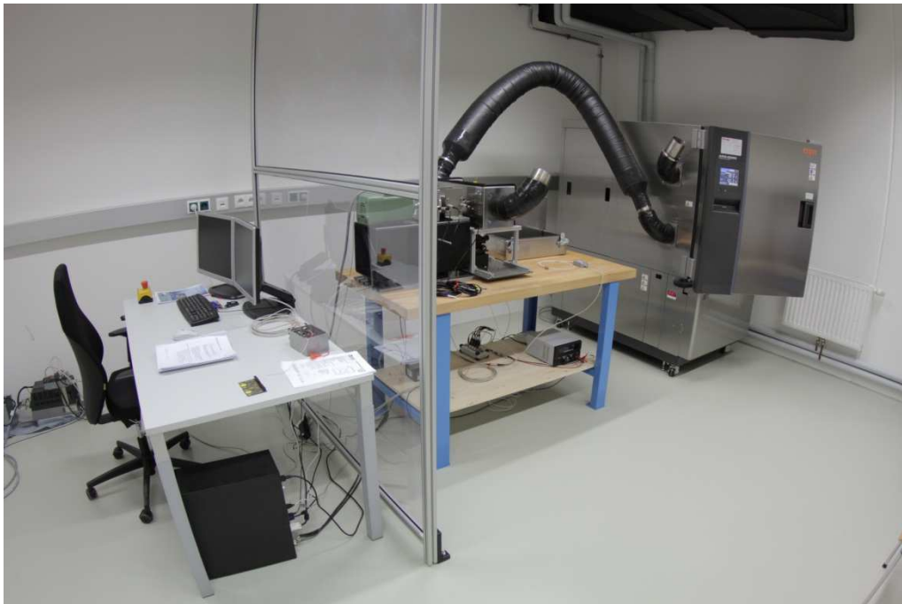
Abb. 19: Prüfstandsraum mit Temperaturschrank, Zuleitungen, Prüfplatz und Arbeitsplatz (v.R.n.L.)
