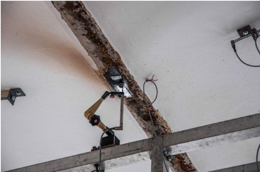
Abbildung 45 - Induktiver Wegaufnehmer und DMS am Träger, D. ü. 2.OG
