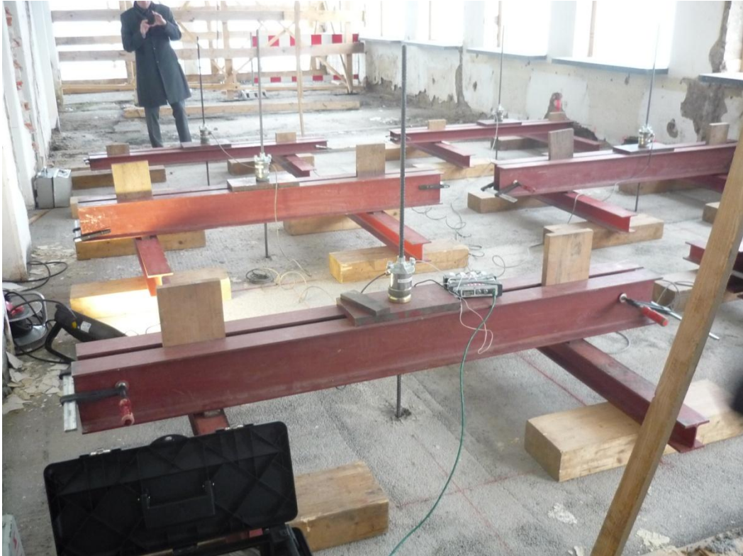
Abbildung 46 - Lasteinleitung und -verteilung mit Kraftmessdosen, 3. OG
