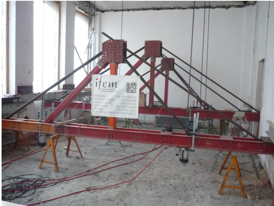
Abbildung 42 - Versuchsaufbau, Belastungsrahmen mit Hydraulikzylindern und Zugstäben, 1.OG
