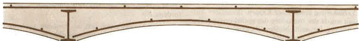
Abbildung 8 - Bewehrte Betonkappendecke nach Monier, 1881 [11]
