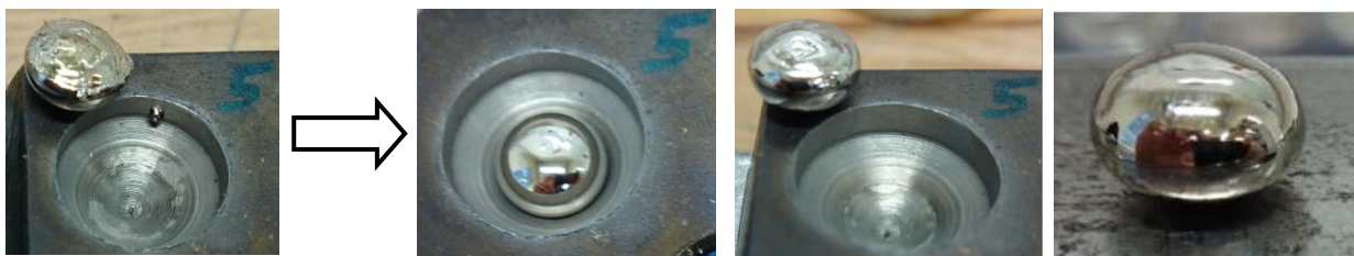
Abbildung 59: Fotografien einer Nickelumschmelzung – Ausgangsprobe (links) und erhaltene Proben nach erfolgtem Umschmelzvorgang (rechts)
