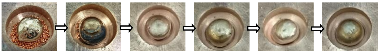
Abbildung 63: Fotografien der Probe V2_TR4_05.01. im Ausgangszustand und nach jedem Aufschmelzzyklus
