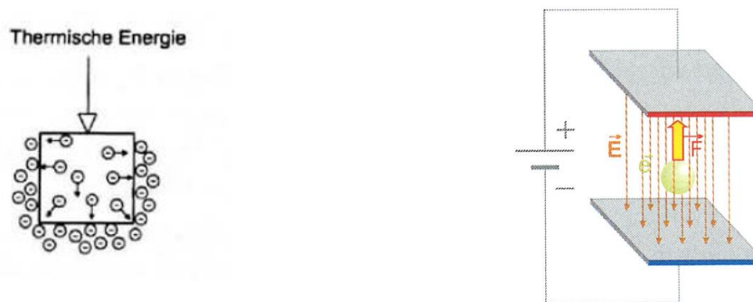
Abbildung 2: Schematische Darstellung des Austretens freier Elektronen nach Erwärmung eines Metalls (links) 11 und wirkende Coulomb-Kraft F auf ein Elektron e^- in einem elektrischen Feld E (rechts) 12
