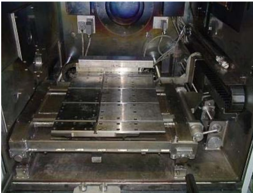
Abbildung 24: Blick in die geöffnete Arbeitskammer der EBW-Anlage des IWS 107
