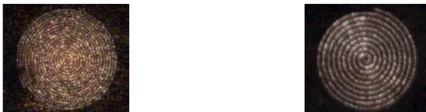
Abbildung 53: Figuren-„Abdrücke“ zweier Ablenkfigur-Tests auf austenitischem Stahlblech von Spirale1000 (links) und Spirale1000_umruehr (rechts), jeweils mit den Parametern I_B=5\text{mA} , U_B=120\text{kV} , A=12\text{mm} , t_B=5\text{s} , f=50\text{Hz} , fokussiert auf die Blechoberfläche
