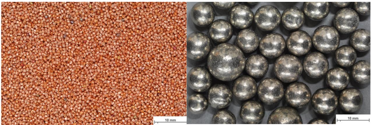
Abbildung 50: Ausgangswerkstoffe Cu (links) und Ni (rechts)
