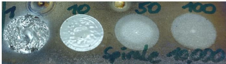
Abbildung 54: Figuren-„Abdrücke“ auf austenitischem Stahlblech von Ablenkfigur Spirale 10000 mit den Parametern I_B=5\text{mA} , U_B=120\text{kV} , A=12\text{mm} , t_B=5\text{s} , f=1/10/50/100\text{Hz} , fokussiert auf die Blechoberfläche
