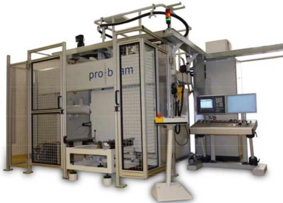
Abbildung 23: Gesamtansicht der EBW-Anlage des IWS 106
