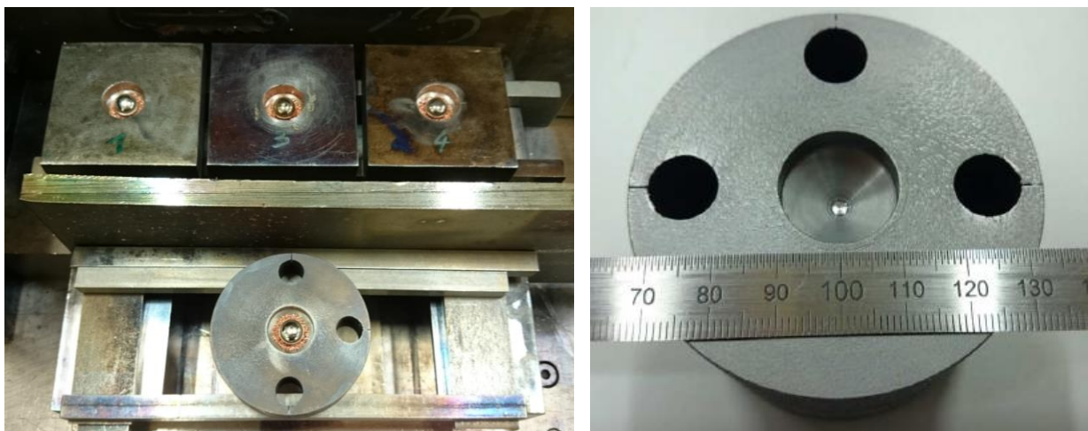
Abbildung 49: Verwendete Stahltiegel (links oben) und TZM-Tiegel (links unten) nach Positionierung der Ausgangswerkstoffe, ungebrauchter TZM-Tiegel (rechts)
