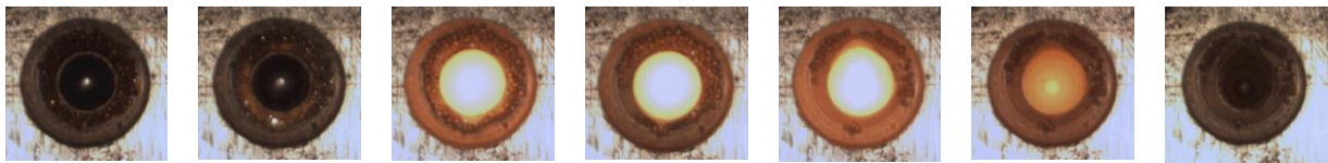
Abbildung 65: Bildfolge des ersten Aufschmelzversuchs von Probe V1_TR6_15.01. , m_{Ni}=4,70g , m_{Cu}\sim 2,01g , Spirale10000, A=12mm , f=500Hz , I_B=2,9mA , U_B=120kV , t_B=46s , Nachwärmung 1,5mA über 10s und 1mA über 10s
