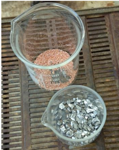
Abbildung 71: Cu shots und die durch hydraulisches Pressen und Stanzen veränderten Nickel shots
