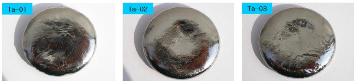
Abbildung 18: Ta-Knopfproben nach zwei- (links), vier- (mittig) und sechs Umschmelzungen (rechts) 82
