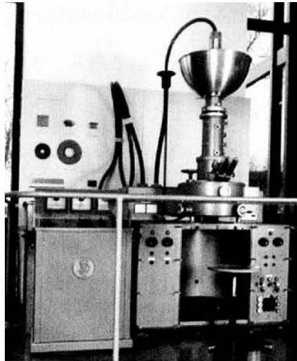
Abbildung 1: Erste Elektronenstrahlschweißmaschine zum Tiefschweißen (1958), U_A=55\text{kV} , I_B=20\text{mA} 6
