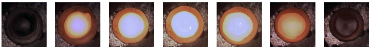
Abbildung 61: Bildfolge des achten Aufschmelzversuchs von Probe V1_TR6_02.01. mit realisiertem "Umrührprozess", m_{\text{Ni}} \sim 4,18\text{g} , m_{\text{Cu}} \sim 4,74\text{g} , Spirale10000/Spirale1000, A=12\text{mm} , f=500\text{Hz}/1\text{Hz} , I_B=4,3\text{mA} , U_B=120\text{kV} , t_B=25\text{s}/5\text{s} , Nachwärmung 1,5mA über 10s
