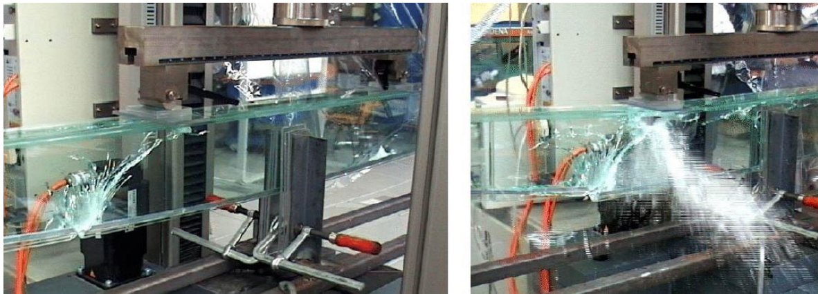
Abb. 7-5 Spannglasträger während des 4-Punkt-Biegeversuchs [16]
