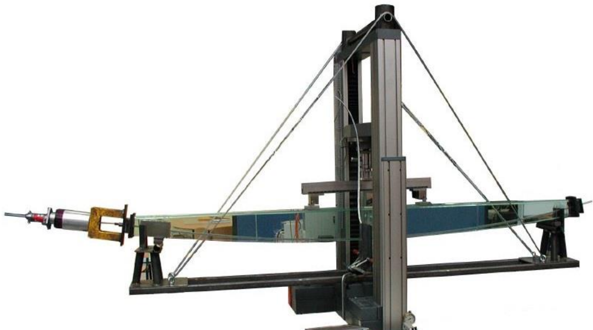
Abb. 7-4 Spannglastträger im 4-Punkt-Biegeversuchsgerät [16]
