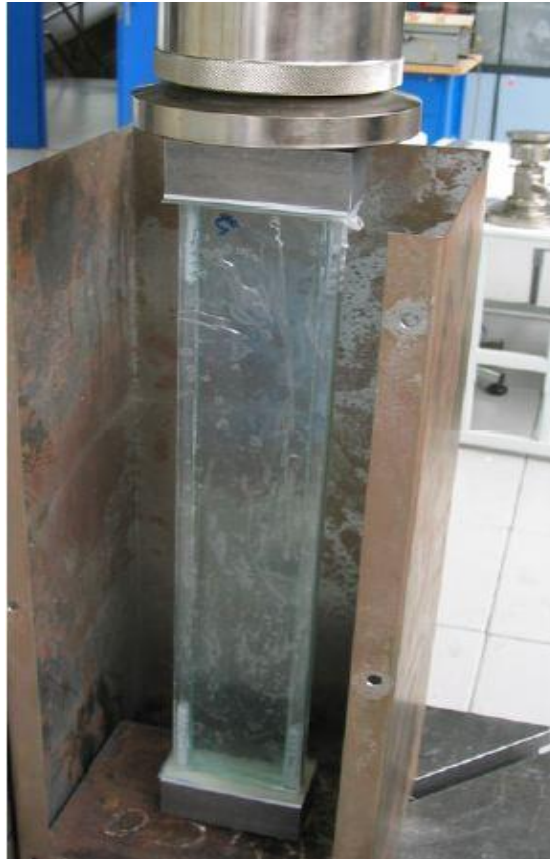
Abb. 7-23 Träger während des Drucktests [23]
