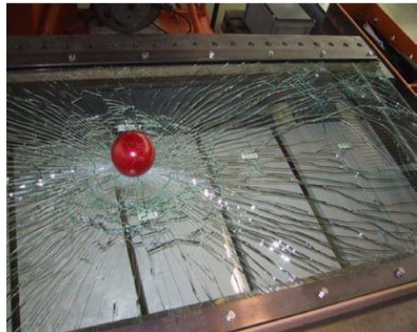
Abb. 3-5 VSG aus TVG nach Kugelabwurf [6]
