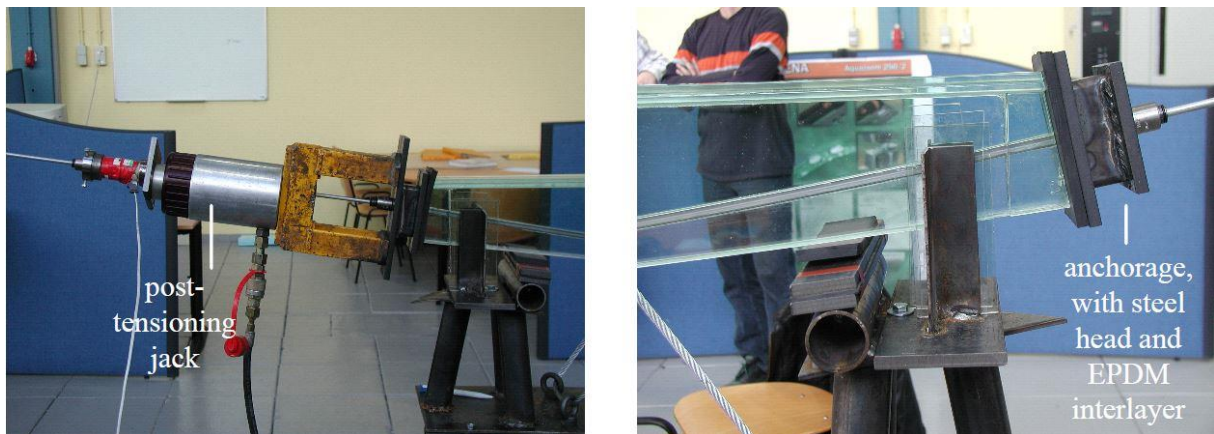
Abb. 7-3 Glasträger während des Vorspannens [16]
