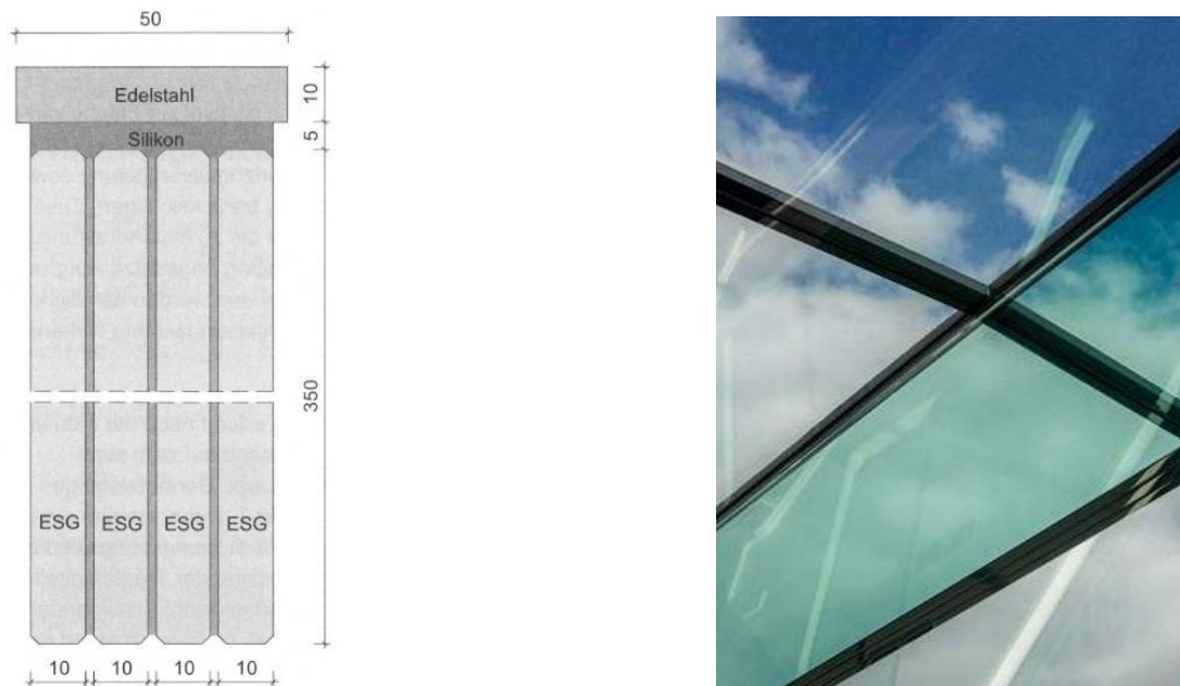
Abb. 5-3 links: Querschnitt des Glasträgers (alle Maße in mm) [14]; rechts: Foto aus Arnold House School [6]
