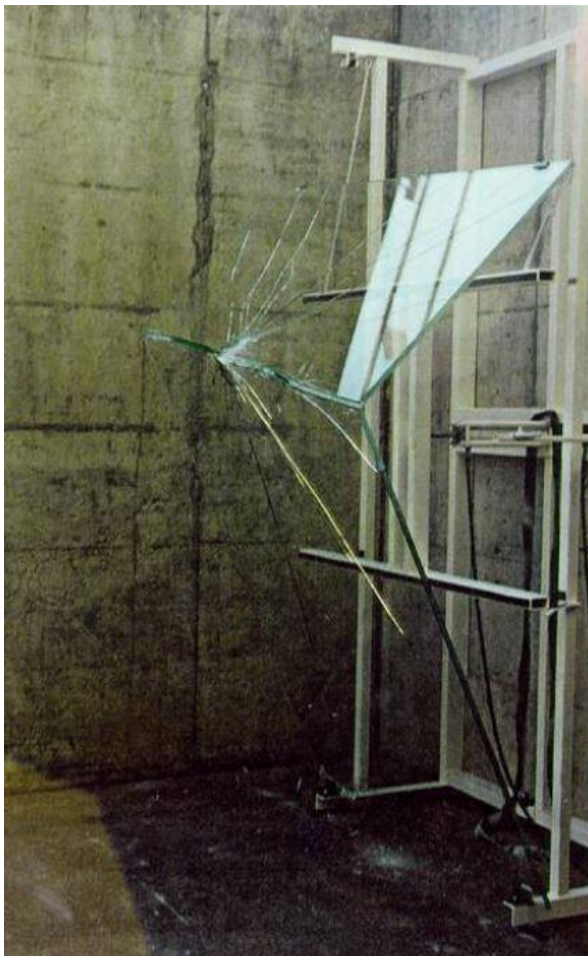
Abb. 3-3 VSG aus Floatglas bei zweiseitiger Lagerung [6]
