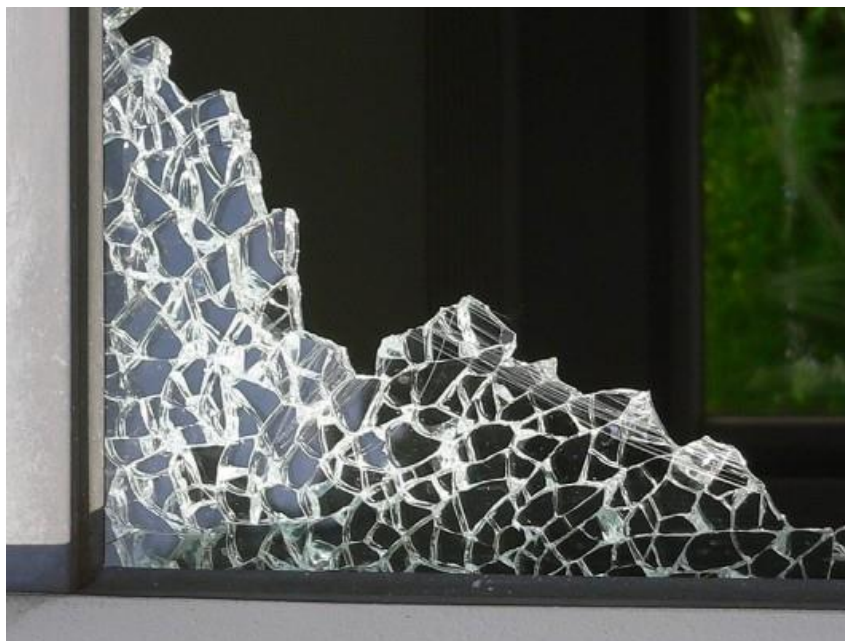
Abb. 2-5 Bruchbild von ESG [1]
