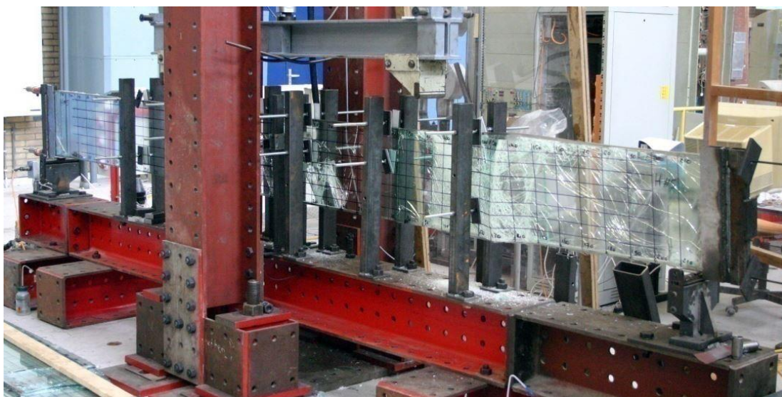
Abb. 7-7 Lokales Knicken des Spannglasträgers [16]
