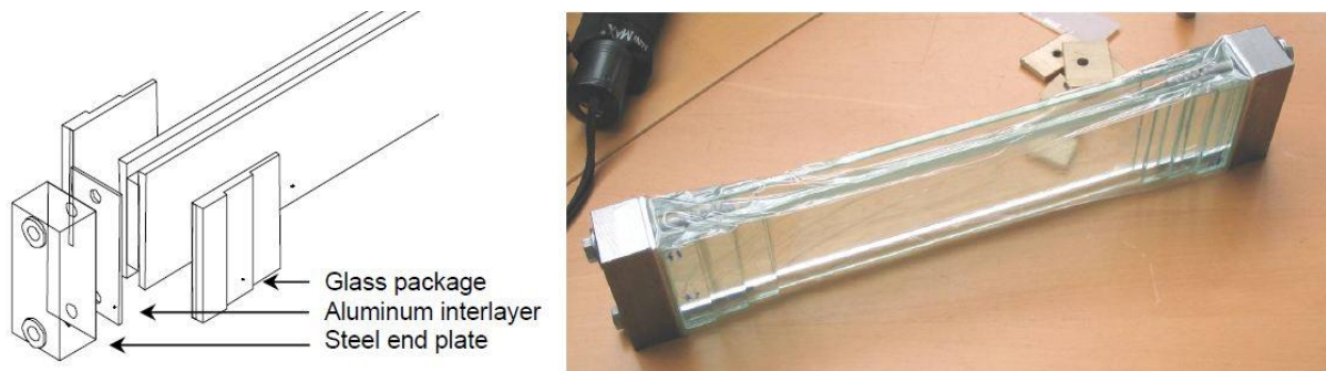
Abb. 7-24 links: Schematische Darstellung des Aufbaus; rechts: Foto des Trägers [23]
