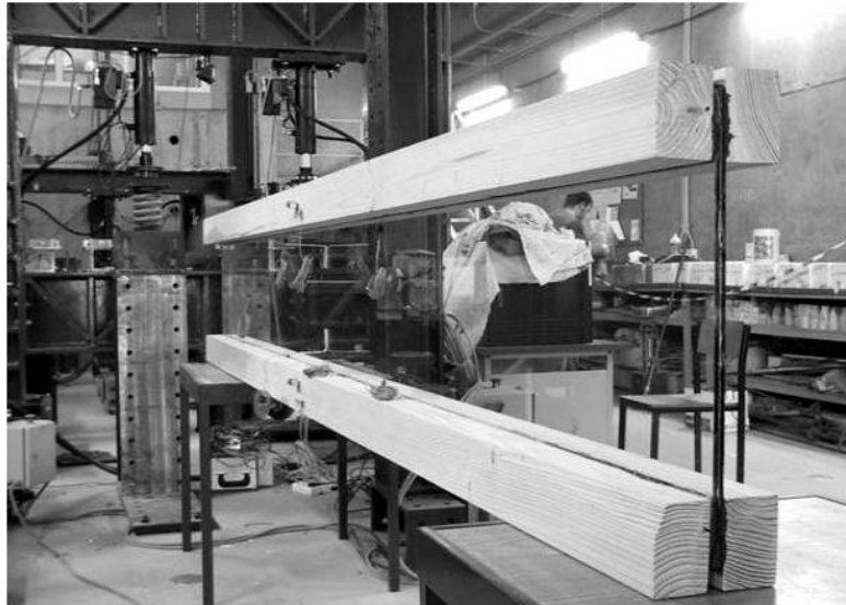
Abb. 5-8 Holz-Glas Hybridträger untersucht von Cruz & Pequeno [16]
