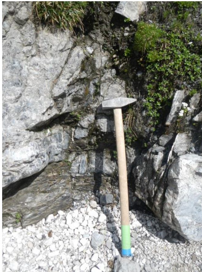
Abb. 15: Aufschlussfoto des gebankten Wettersteindolomits mit sedimentärer Einschaltung einer dunklen Tonschieferlage im Liegenden, WP46.
